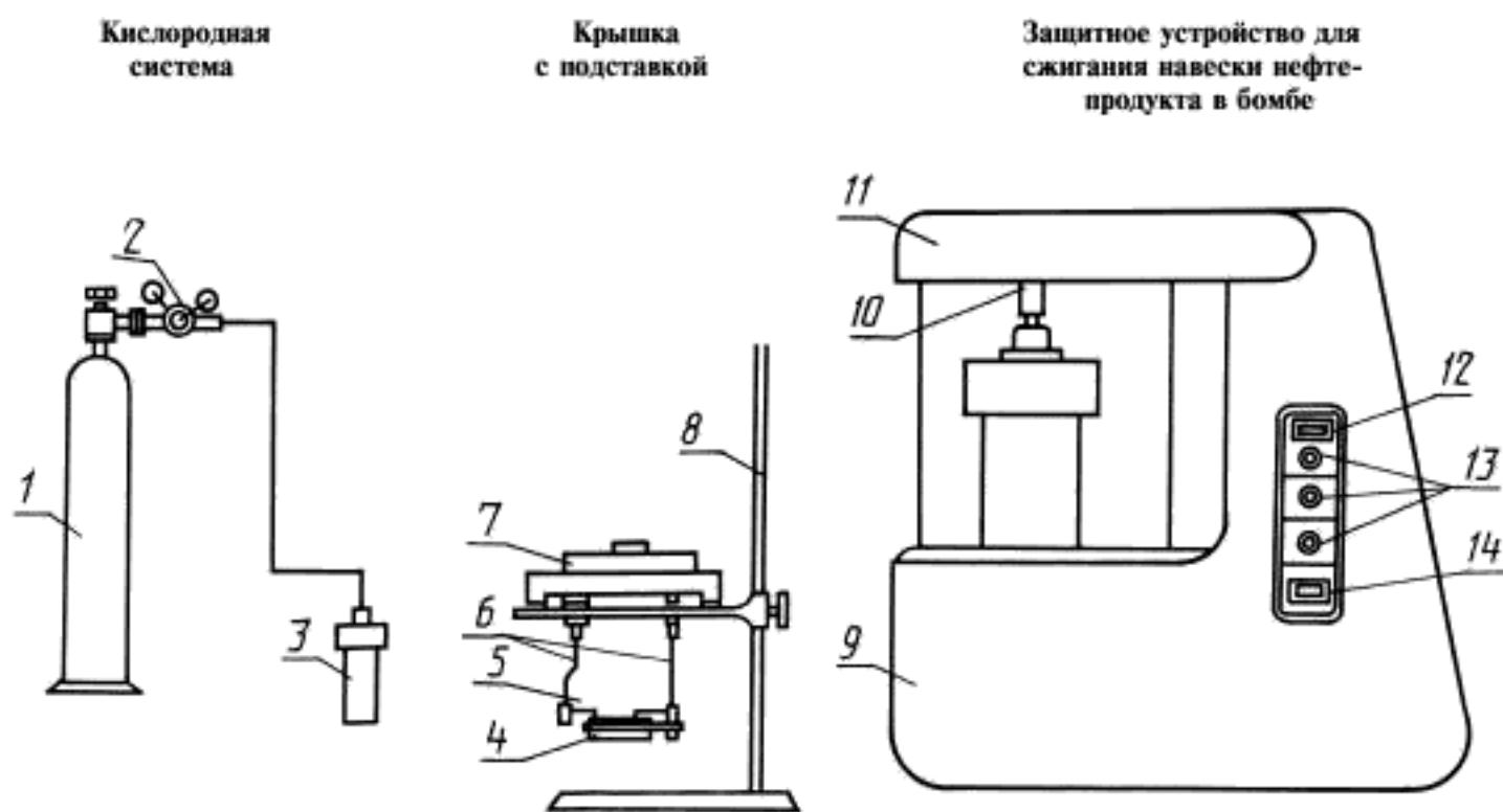
1 — баллон с кислородом; 2 — редуктор; 3 — калориметрическая бомба; 4 — тигель; 5 — запальная проволока; 6 — держатели тигеля и запальной проволоки; 7 — крышка бомбы; 8 — подставка для крышки; 9 — корпус защитного устройства; 10 — клапан для сброса продуктов сгорания; 11 — крышка; 12 — кнопка «Сеть»; 13 — сигнальная лампа; 14 — кнопка «Запал»
