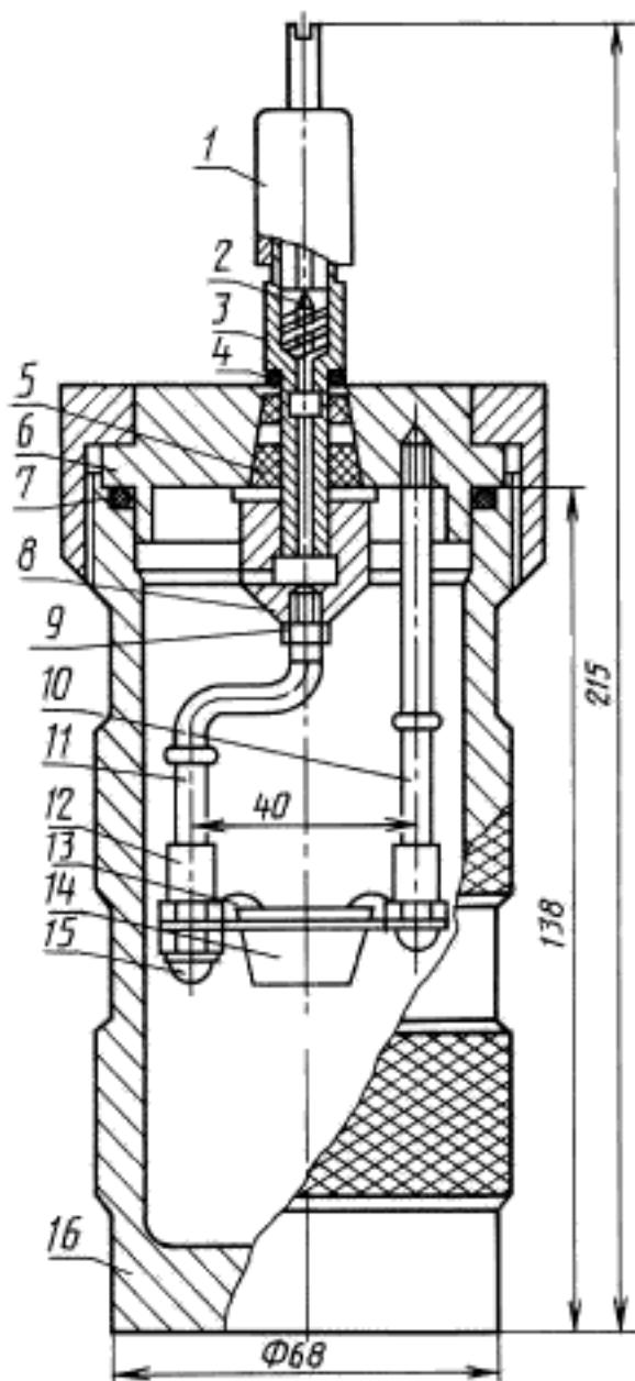
1 — колпачок для сброса продуктов горения; 2 — золотник; 3 — штуцер; 4 — изолятор; 5 — втулка; 6 — крышка; 7 — уплотнительное кольцо; 8 — гайка специальная; 9 — гайка; 10 — стержень; 11 — тиглодержатель; 12 — запальная проволока; 13 — втулка; 14 — тигель; 15 — гайка; 16 — стакан
