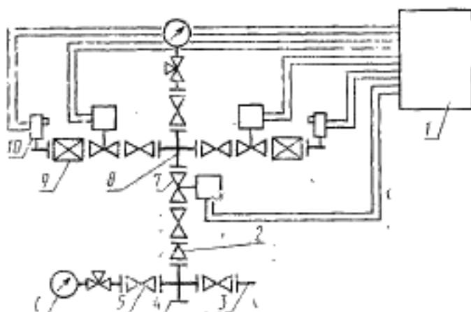
1—станина управления; 2—переводник к трубной головке; 3—ответный фланец; 4—трубная головка; 5—запорное устройство с ручным управлением; 6—манометр с запорно-разрядным устройством; 7—запорное устройство с дистанционным управлением; 8—крестовина; 9—регулируемый дроссель; 10—пневмопилот (автоматическое предохранительное устройство)
