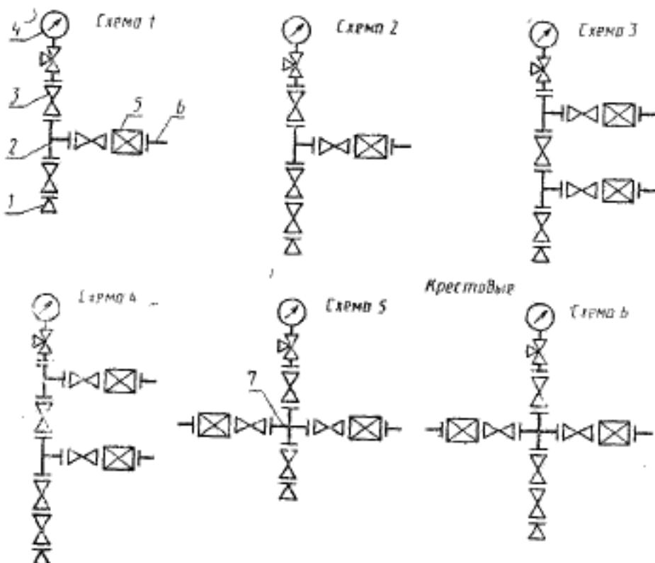
1 — переводчик к трубной головке; 2 — тройник; 3 — запорное устройство; 4 — манометр с запорно-разрядным устройством; 5 — дроссель; 6 — оклопный фланец; 7 — крестовина
