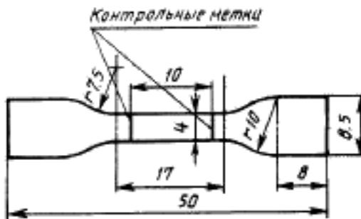
Рисунок 4 — Образец в форме лопатки
