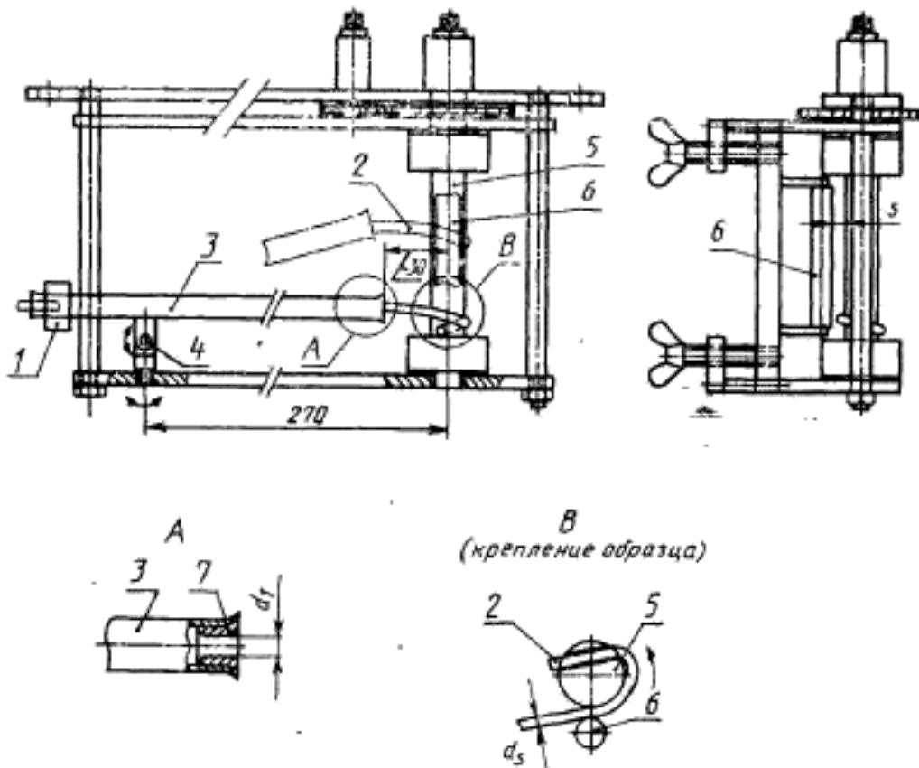
1 — противовес; 2 — испытуемый образец; 3 — трубка; 4 — ось вращения; 5 — стержень; 6 — регулируемая обводная штанга; 7 — сомкю
