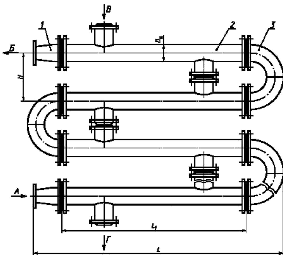
1 — переход исполнения 1 (см. рисунок 11); 2 — блок-секция типа ПВ1; 3 — калач соединительный исполнения 1 (см. рисунок 10);
