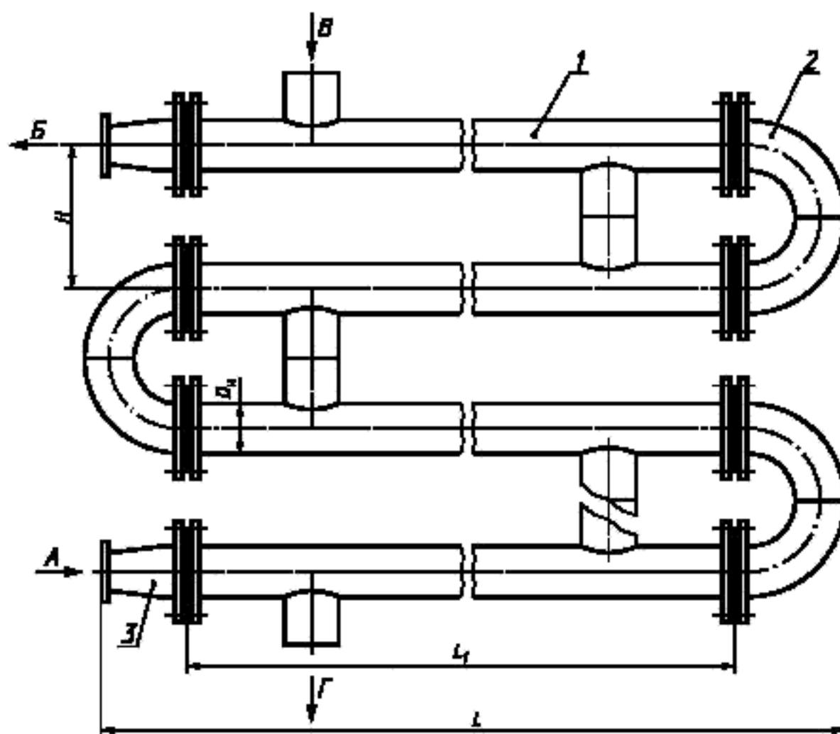
1 — секция типа ПВ2; 2 — соединительный калач исполнения 1 (см. рисунок 10); 3 — переход исполнения 1 (см. рисунок 11);
