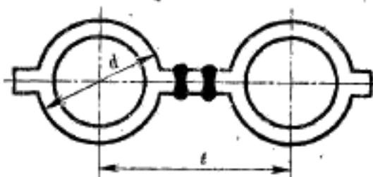
$d$ —наружный диаметр трубы;  $l$ —расстояние между осями труб
