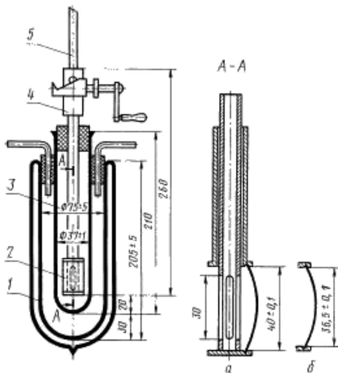
1 — сосуд Дьюара; 2 — пластинка; 3 — пробирка; 4 — устройство для сгибания пластинки; 5 — термометр
