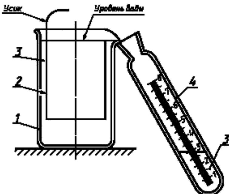
1 — стакан с носиком; 2 — образец; 3 — вода; 4 — пробирка
