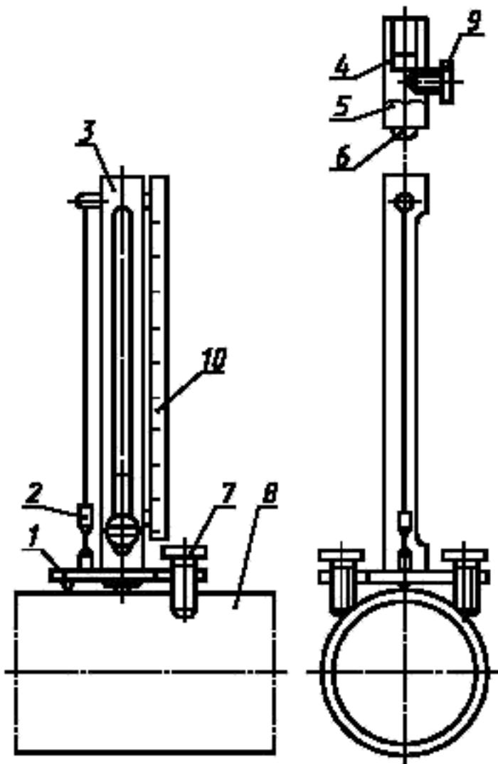
1 — основание; 2 — отвес; 3 — направляющая; 4 — стакан бойка; 5 — падающий боек массой  $(1 \pm 0,01)$  кг; 6 — стальной шарик диаметром 16 мм, твердостью HRC 80; 7 — регулируемые ножки; 8 — испытуемый образец; 9 — винт-рукоятка; 10 — шкала от 0 до 50 см
