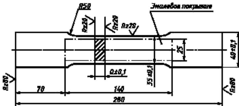
Рисунок К.1 — Форма и размеры образца для испытания эмалевого покрытия на растяжение
