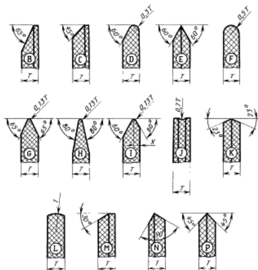
Пример условного обозначения типоразмера круга типа 1, с профилем  $N$ , наружным диаметром  $D=600$  мм, высотой  $T=80$  мм, диаметром посадочного отверстия  $H=305$  мм:
