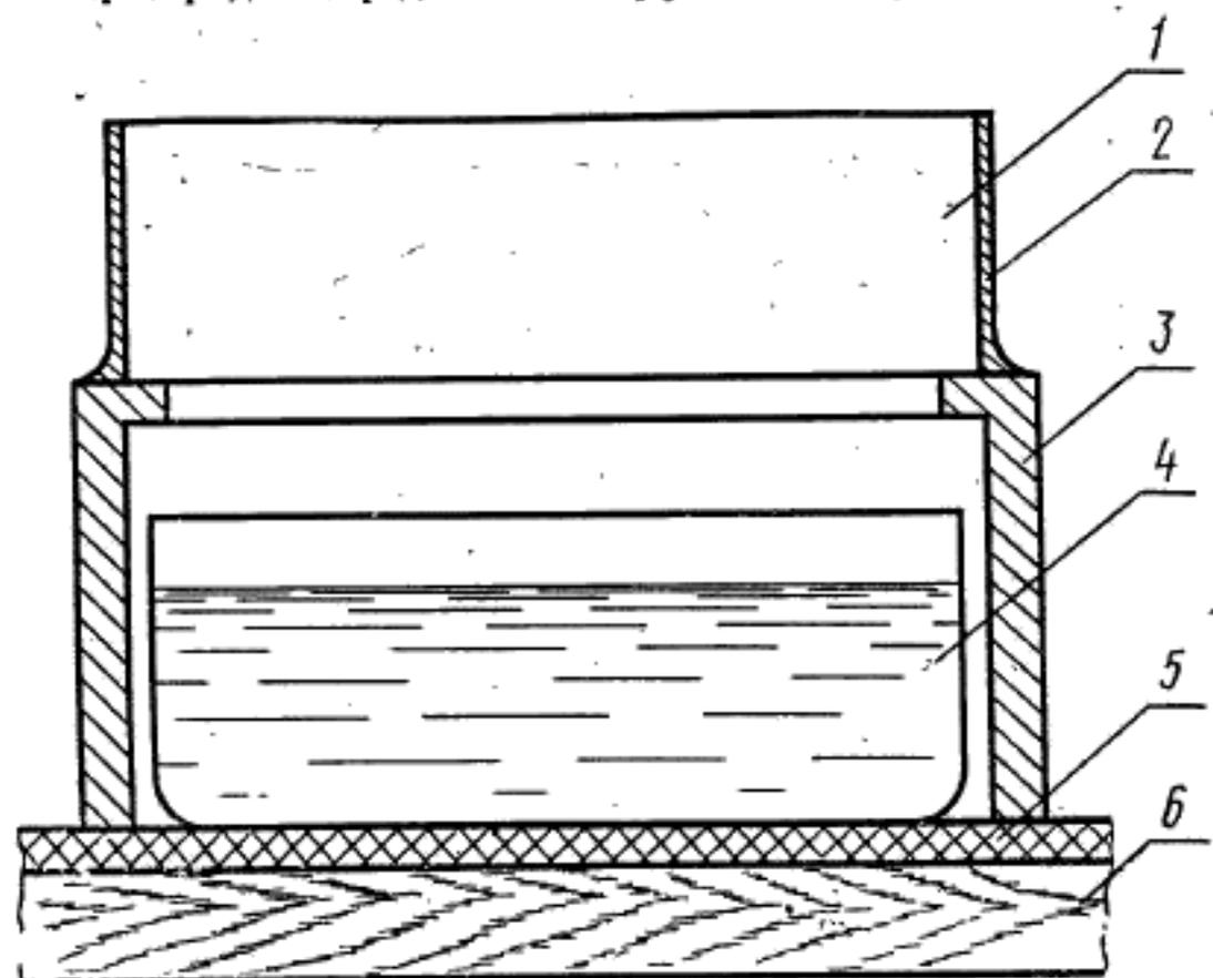
1 — образец ячеистого бетона; 2 — паронизоляция; 3 — металлическая труба; 4 — стеклянная чашка с насыщенным раствором сульфата калия ( $K_2SO_4$ ); 5 — листовая мягкая резина; 6 — стеллаж
