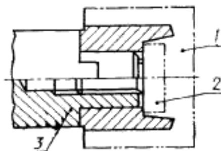
1—фреза; 2—стопорный винт; 3—центрирующая часть опорки
