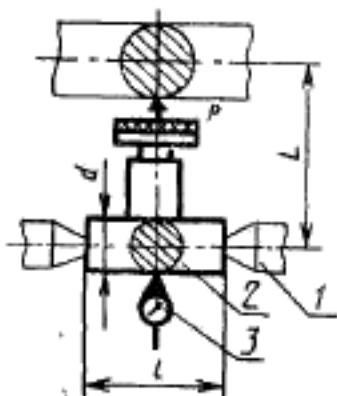
Для станков с вертикальным расположением оси обрабатываемого колеса
