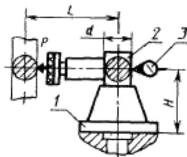
$d$  — диаметр испытательной оправки;  $L$  — расстояние между осями заготовки и шевера;  $l$  — длина испытательной оправки;  $H$  — расстояние от торца шпинделя до точки приложения силы
