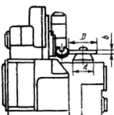
$D$  — наибольший диаметр обрабатываемого зубчатого колеса;  $L$  — наибольшая длина обрабатываемого зубчатого колеса;  $b$  — наибольшая ширина венца обрабатываемого зубчатого колеса;  $d$  — диаметр стола (фланца шпинделя изделия)
