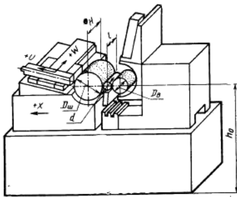
$d$  — наибольший диаметр устанавливаемой заготовки;
