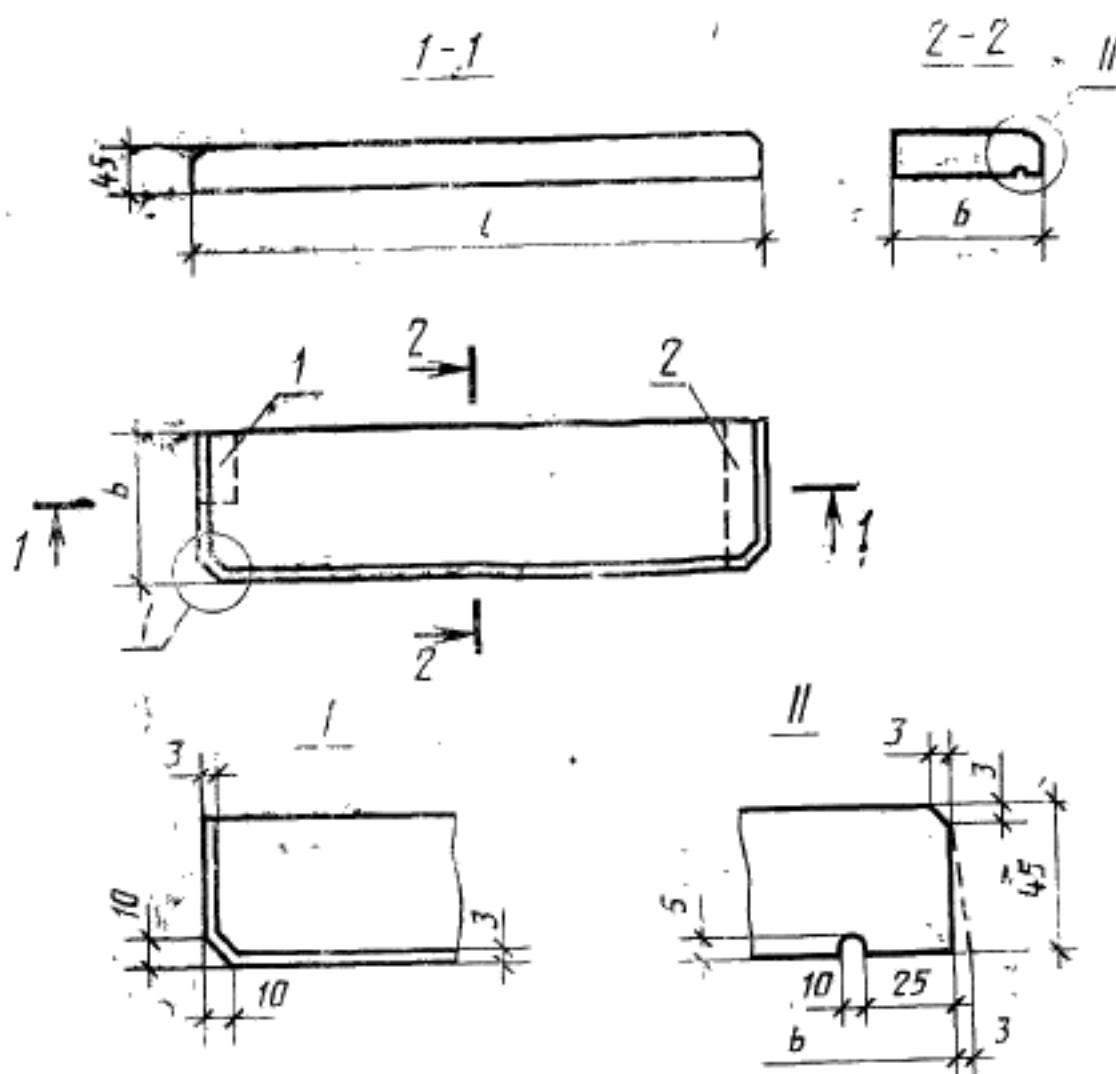
1 — вырез; 2 — срез торца; 3 — технологический уклон не более 3 м/m.
