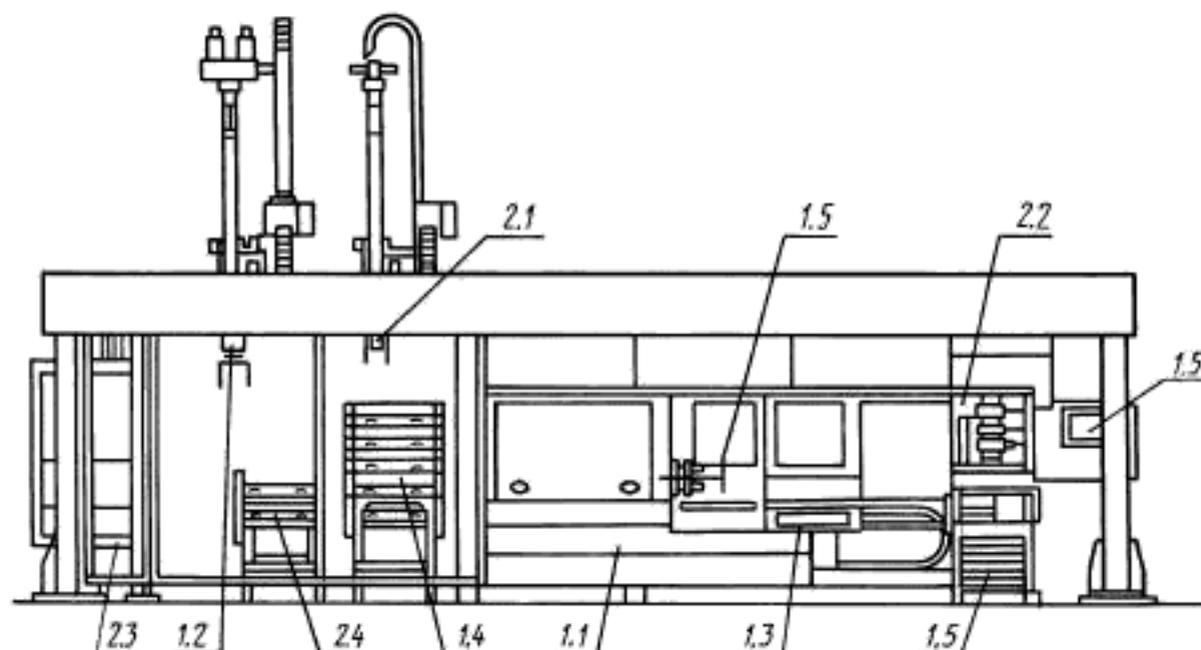
1.1 — токарный или токарно-многоцелевой полуавтомат или станок с ЧПУ, 1.2 — промышленный робот, 1.3 — система управления ГПМ, 1.4 — накопитель заготовок и изделий, 1.5 — устройство контроля состояния инструмента и его автоматической привязки, 2.1 — промышленный робот для замены режущего инструмента, 2.2 — накопитель инструментов, 2.3 — накопитель зажимной оснастки, 2.4 — накопитель бракованных изделий
