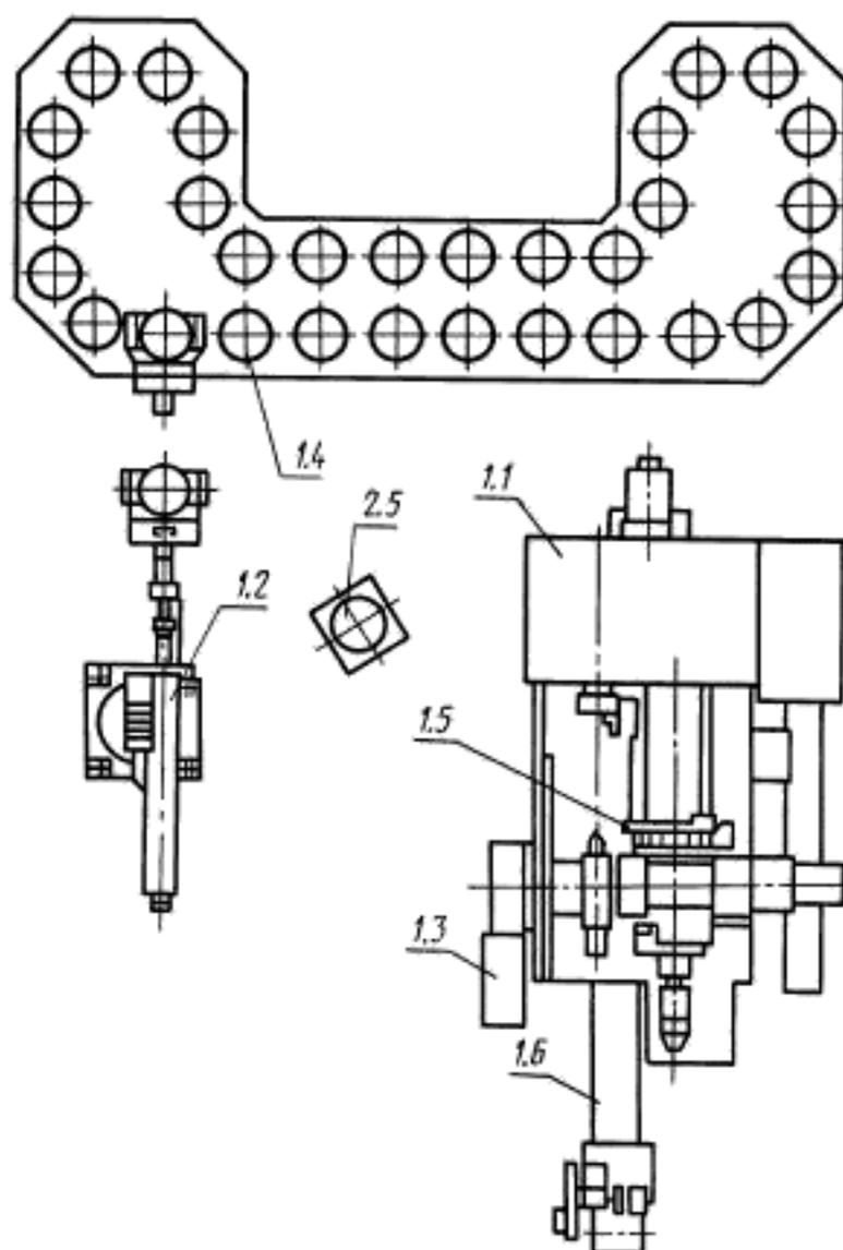
1.1 — токарный или токарно-многоцелевой полуавтомат или станок с ЧПУ, 1.2 — промышленный робот, 1.3 — система управления ГИМ, 1.4 — накопитель заготовок и изделий, 1.5 — устройство измерения деталей на станке, 1.6 — устройство удаления отходов, 2.5 — устройство для кантования изделия
