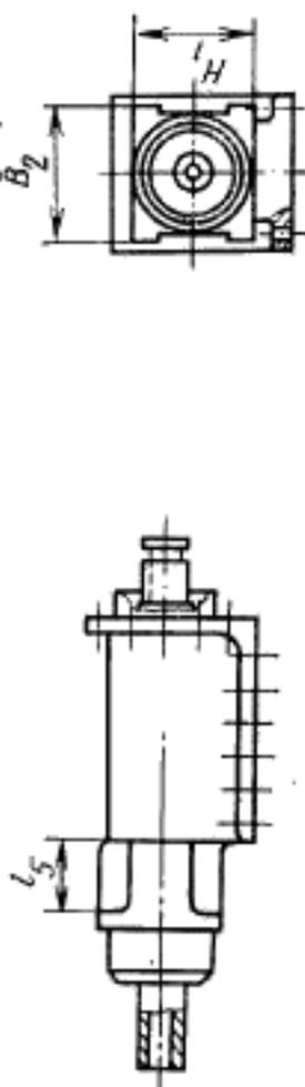
\*  $l_6$  — (расстояние между крепежными отверстиями) через 25 мм иликратно 25 мм
