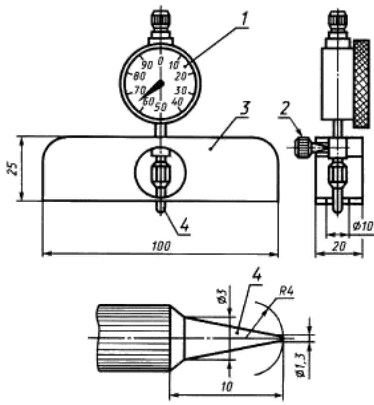
1 — шкала индикатора; 2 — стопорный винт; 3 — колодка;
