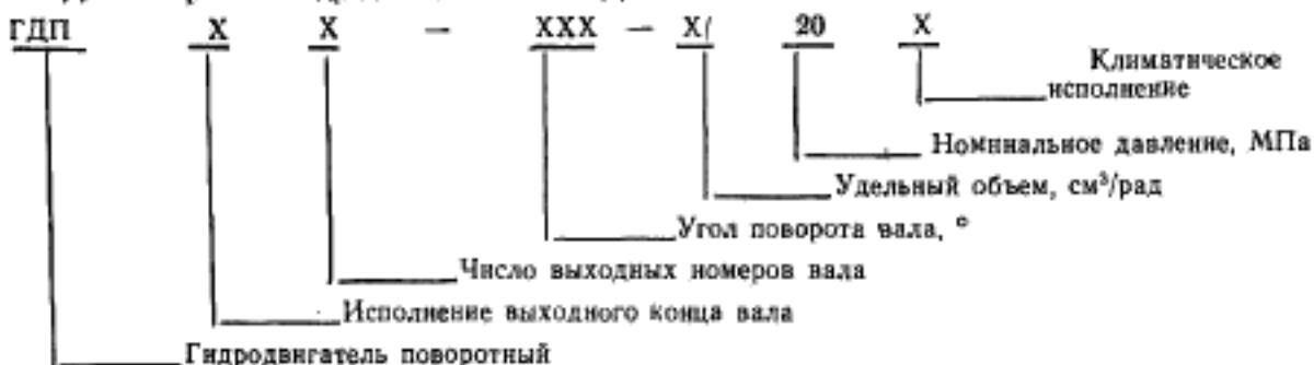
Пример условного обозначения поворотного гидродвигателя со шпоночным исполнением вала, с одним выходным концом, с углом поворота 270°, удельным объемом 400 см³/рад, номинальным давлением 20 МПа, в климатическом исполнении УХЛ4:
