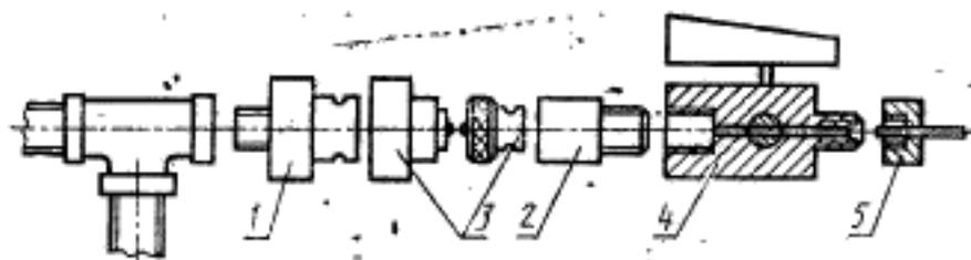
1 — запорный клапан, постоянно подсоединенная часть быстроразъемного соединения; 2 — съемная часть быстроразъемного соединения (если применяется); 3 — защитные крышки; 4 — сферический кран; 5 — насадок
