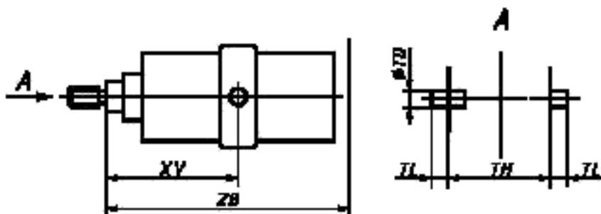
Рисунок 4 — Крепление гидроцилиндра на промежуточных закрепленных или подвижных цапфах (МТ4)
