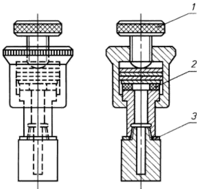
1 — зажимной винт; 2 — испытуемый образец; 3 — металлическая прокладка
