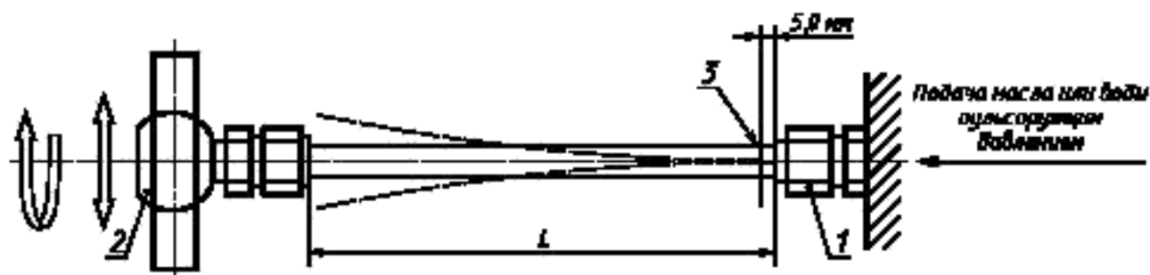
1 — испытуемый образец; 2 — движущийся конец; 3 — место установки тензодатчика
