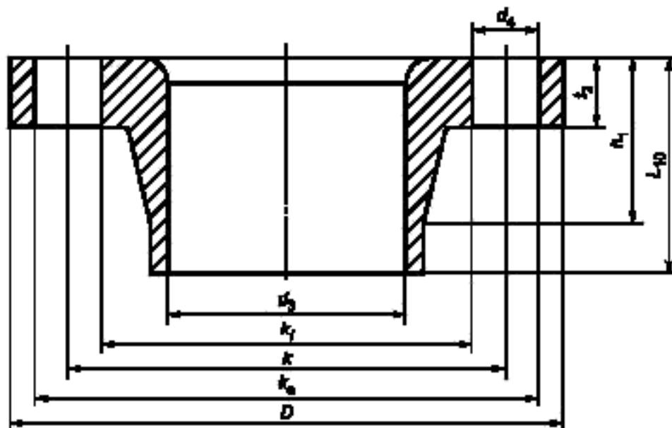
Рисунок 6 — Размеры фланцевой втулки
