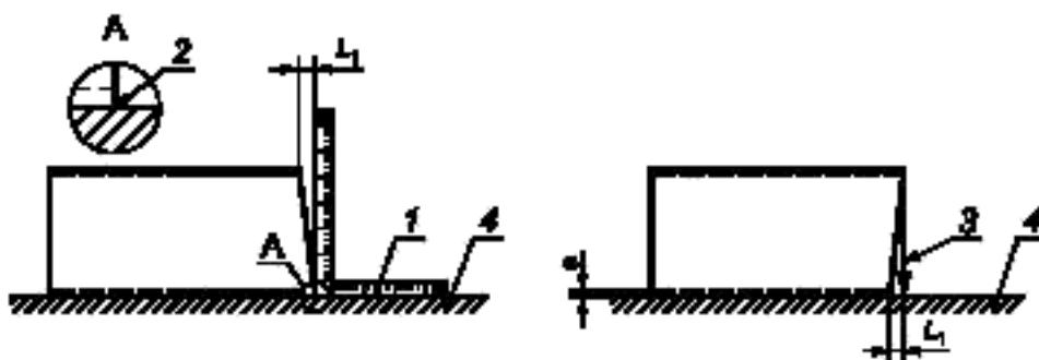
1 — стальной угольник 90°; 2 — точка контакта; 3 — свинцовый отвес; 4 — поверчная плита
