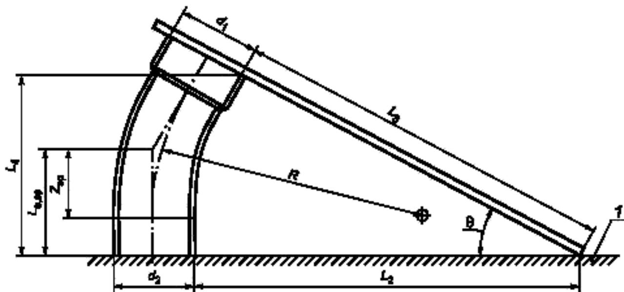
б — Отвод установлен на трубный конец
