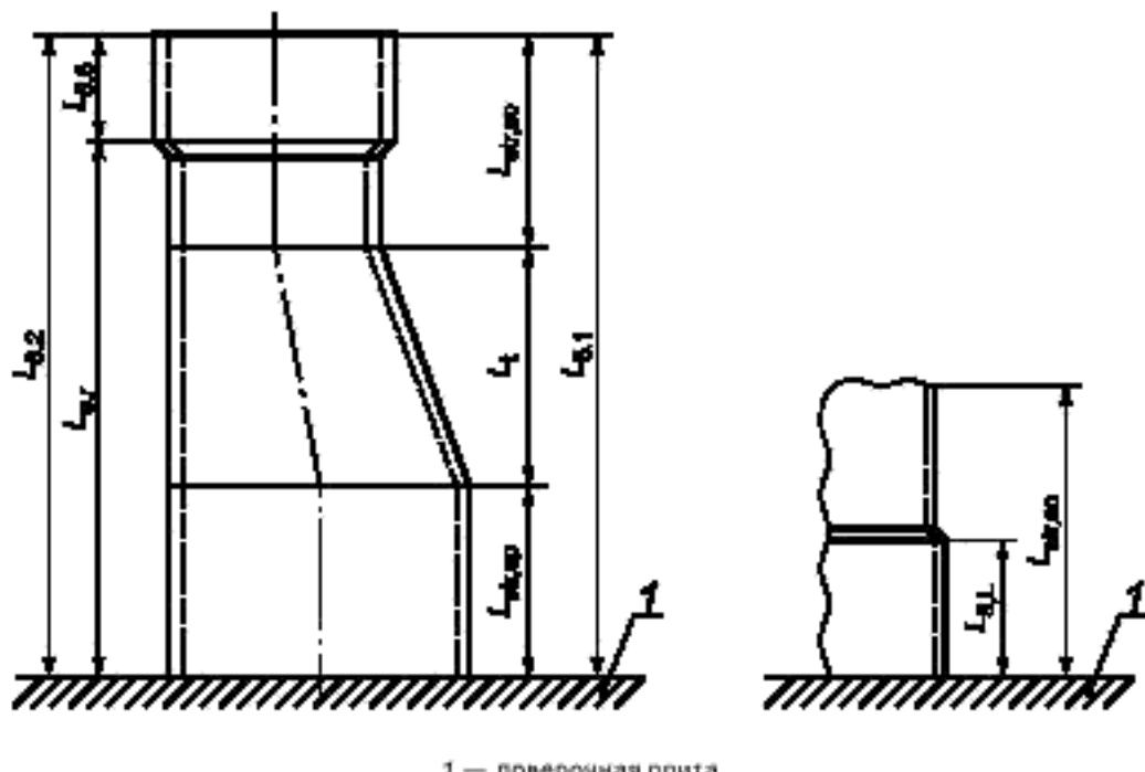
Рисунок 5 — Определение эффективной длины перехода
