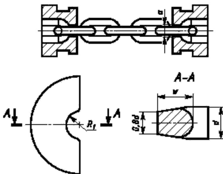
$a$  — размер  $d_1$  из таблицы 1;  $d$  —名义ный диаметр материала (проката) в готовой цепи;  $R_f = \frac{a}{2}$ ;  $w$  — в зависимости от размеров захватов.
