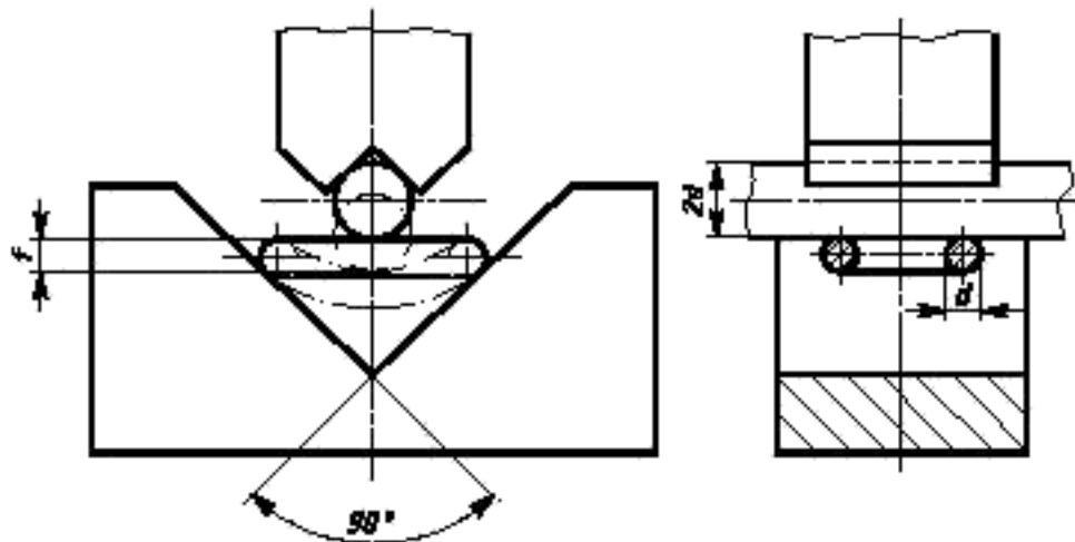
Рисунок 6 — Испытание на изгиб
