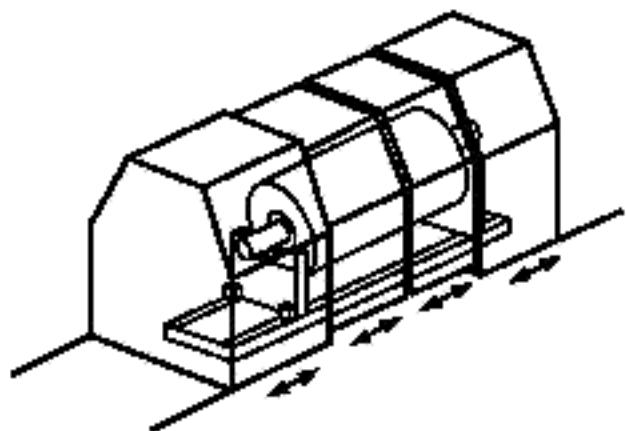
Рисунок С.3 — Телескопический кожух, полностью охватывающий балансировочный станок
