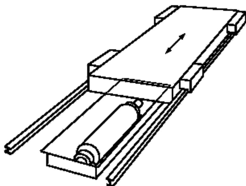
Рисунок С.5 — Приямок с крышкой для высокоскоростного балансировочного станка
