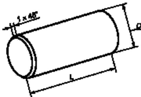
Рисунок А.3 — Стандартный ударник тупоголовой формы
