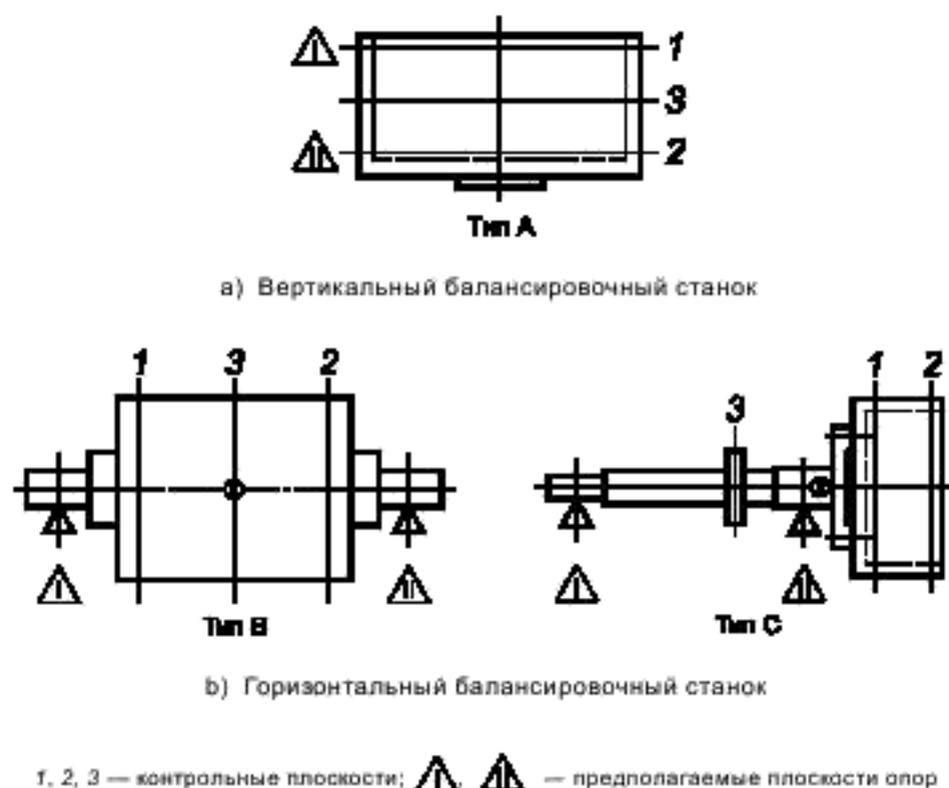
**Примечание** — Для роторов типов А и В центр масс расположен между опорами, для ротора типа С — на консольной части ротора.
