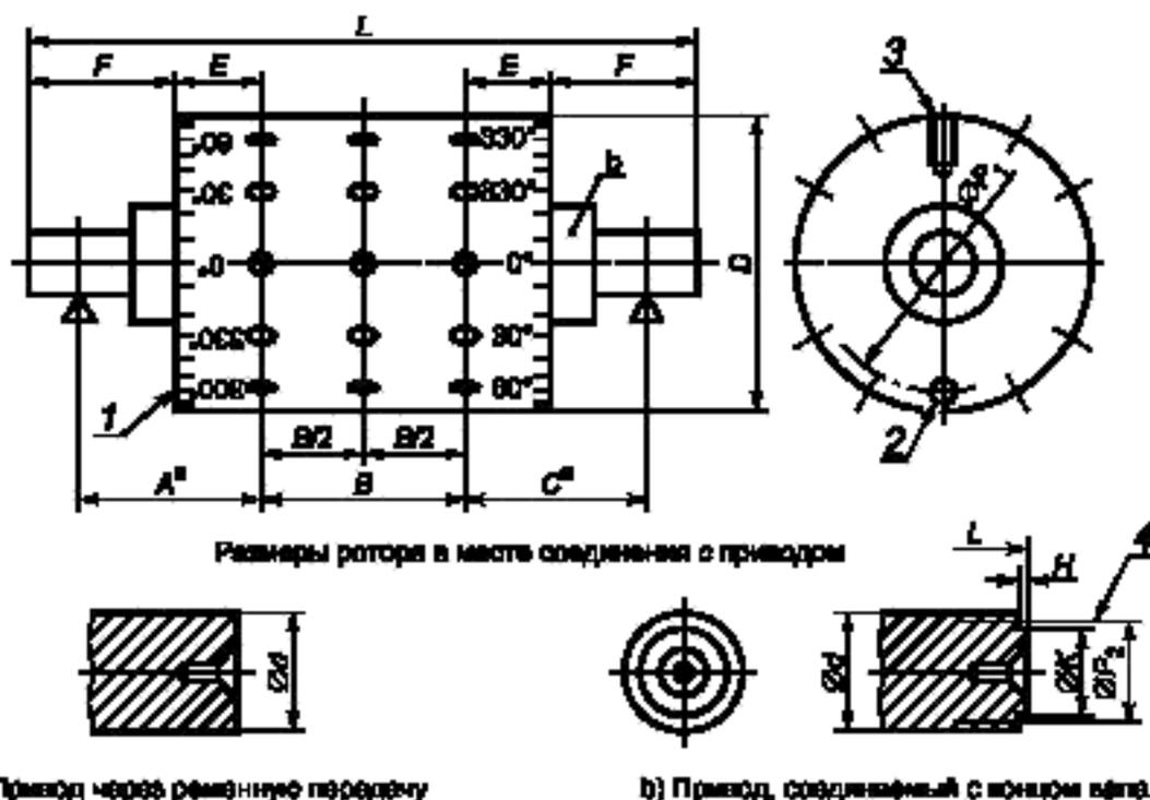
1 — разметка шкал (36 отметок через каждые 10°, пронумерованные через каждые 30° по часовой стрелке и против часовой стрелки); 2 — резьбовые отверстия N (по 12 эквидистантных отверстий в каждой торцевой плоскости для точной балансировки); 3 — резьбовые отверстия N (по 12 эквидистантных отверстий в каждой контрольной плоскости); 4 — размер и длина резьбы конца ротора зависит от используемого привода
