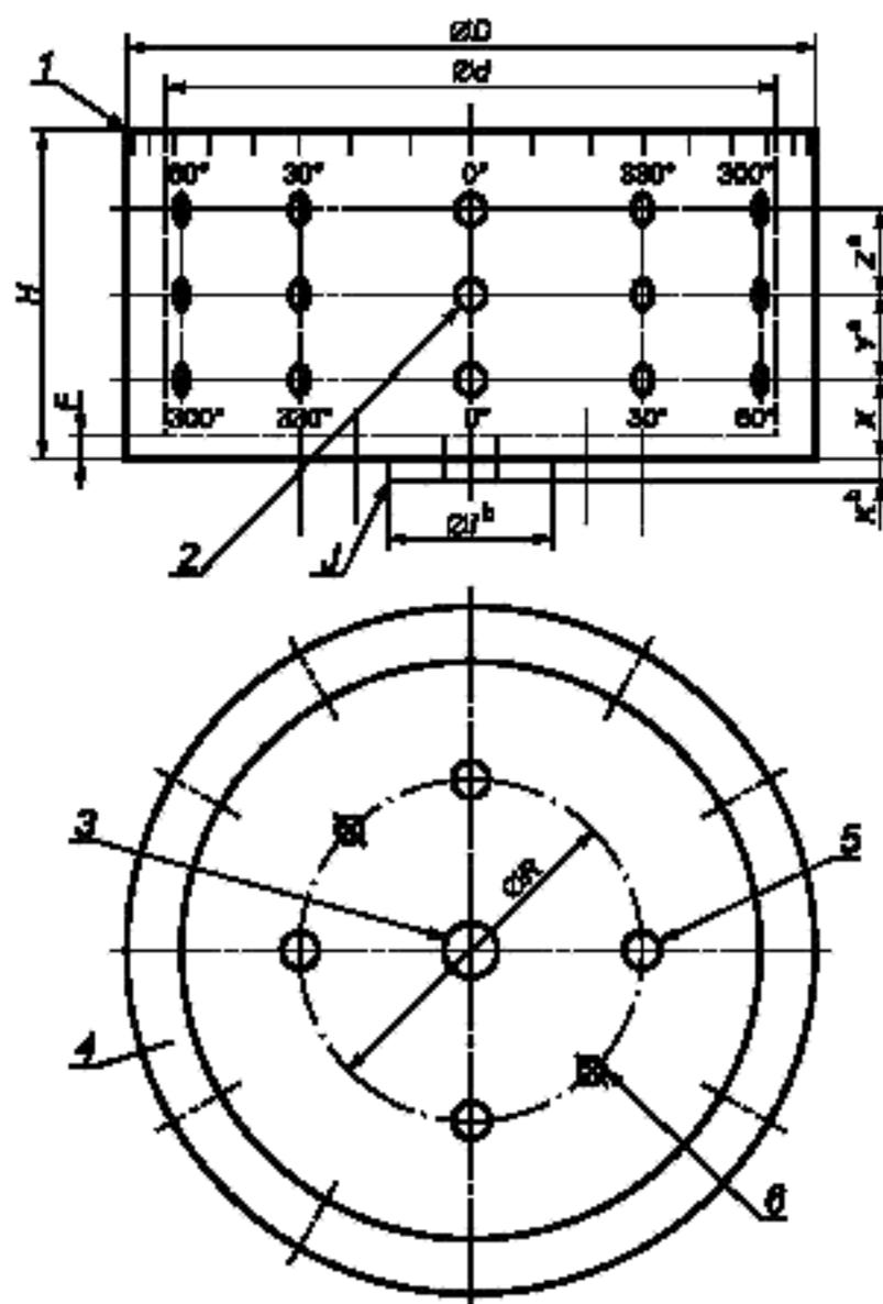
1 — разметка шкал (36 отметок через каждые  $10^\circ$ , пронумерованные через каждые  $30^\circ$  по часовой стрелке и против часовой стрелки); 2 — резьбовые отверстия G (всего 36 — по 12 эквидистантных отверстий в каждой из трех контрольных плоскостей); 3 — резьбовое отверстие для подъема и установки ротора; 4 — место возможной установки корректирующих масс для балансировки ротора; 5 — четыре сквозных равномерно расположенных отверстия O; 6 — два резьбовых отверстия G
