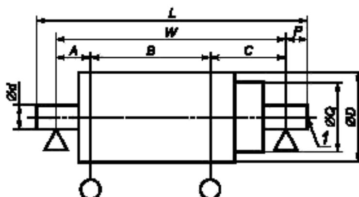
$f$  — приводной вал;  $\bigcirc$  — плоскость коррекции;  $\Delta$  — плоскость опоры,  $Q$  — диаметр шкива ременного привода
