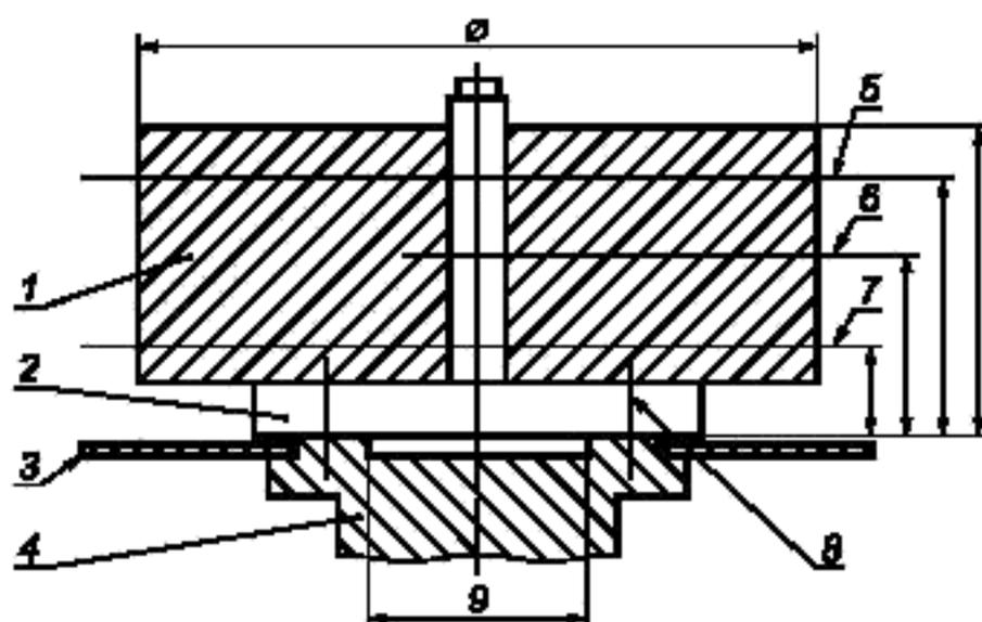
1 — ротор; 2 — переходник; 3 — угломер; 4 — шпиндель; 5 — верхняя плоскость коррекции; 6 — плоскость центра масс; 7 — нижняя плоскость коррекции; 8 — крепежные отверстия для переходника; 9 — центрирующий выступ (диаметр)
