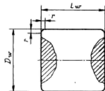
$D_w$ —номинальный диаметр ролика;  $L_w$ —номинальная длина ролика;
