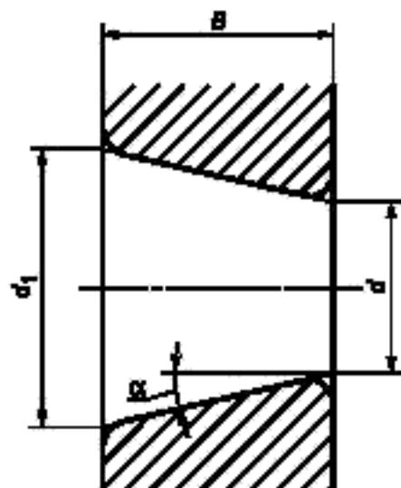
Рисунок 4 — Номинальное коническое отверстие
