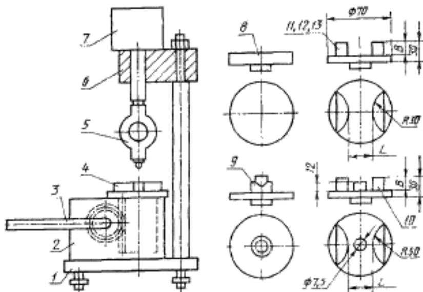
1—основание прибора; 2—редуктор; 3—рукоятка; 4—установочная шайба; 5—твердомер (съёмный); 6—кронштейн; 7—груз; 8, 9—площадки для установки прибора; 10, 11, 12, 13—сменные площадки для установки колец различных сечений
