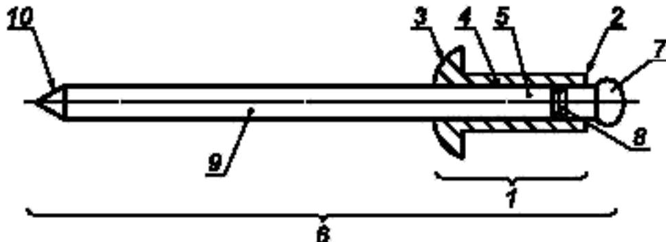
1 — корпус «слепой» заклепки; 2 — конец «слепой» заклепки; 3 — головка «слепой» заклепки; 4 — стержень «слепой» заклепки; 5 — сердцевина «слепой» заклепки; 6 — сердечник; 7 — головка сердечника; 8 — зона отрыва сердечника; 9 — хвостовик сердечника; 10 — конец сердечника
