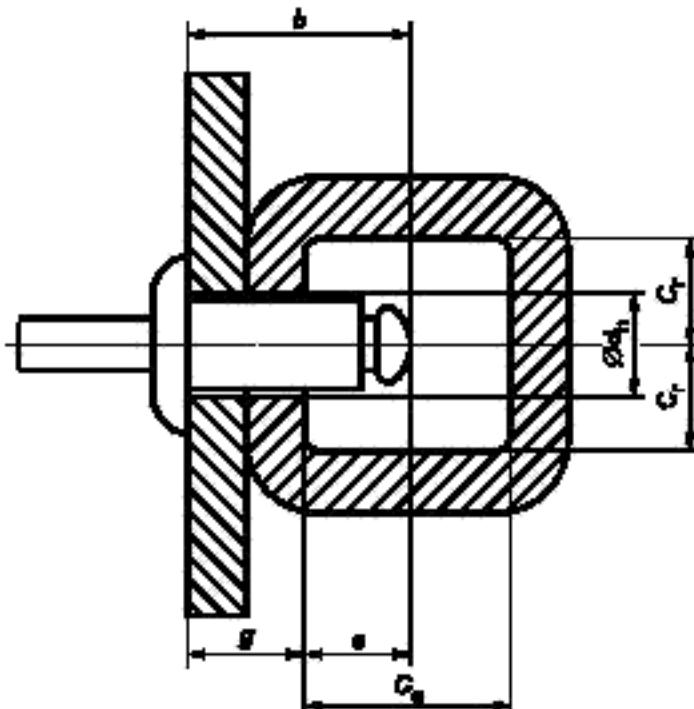
$b$  — слепая длина;  $C_s$  — осевой зазор со «слепой» стороны;  $C_r$  — радиальный зазор со «слепой» стороны;  $d_h$  — диаметр отверстия;  $e$  — выступающая длина «слепой» стороны;  $g$  — толщина пакета
