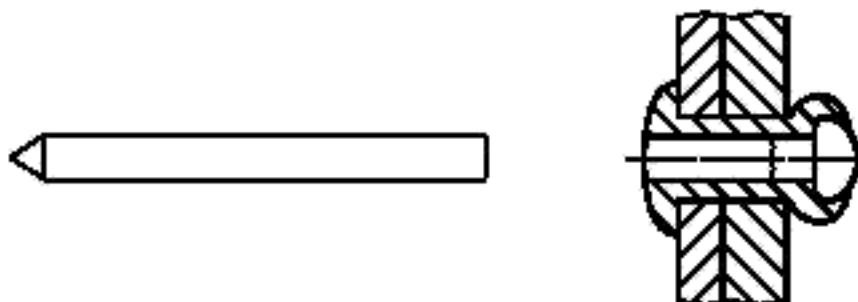
Рисунок 5 — Разрывающийся вытяжной сердечник
