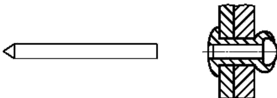
Рисунок 8 — Вытяжной сердечник с заданной точкой разрыва
