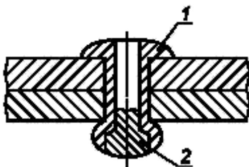
1 — головка «слепой» заклепки; 2 — «слепая» головка
