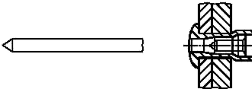
Рисунок 9 — Ступенчатый вытяжной сердечник с заданной точкой разрыва
