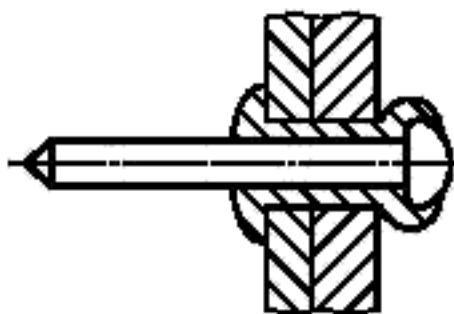
Рисунок 7 — Неразрывающийся вытяжной сердечник
