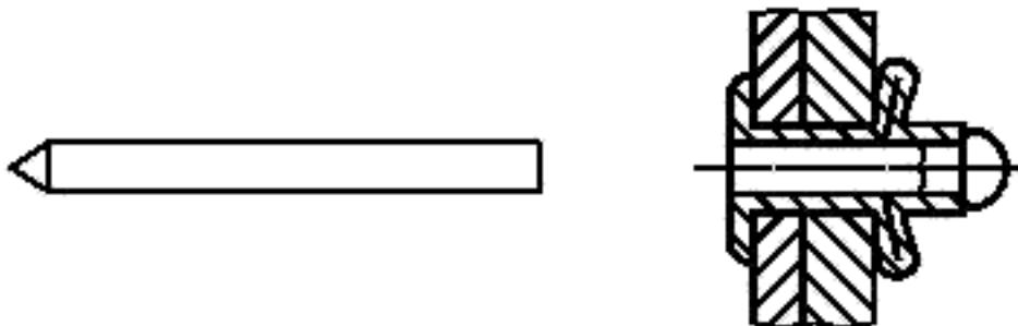
Рисунок 16 — Разрезной стержень
