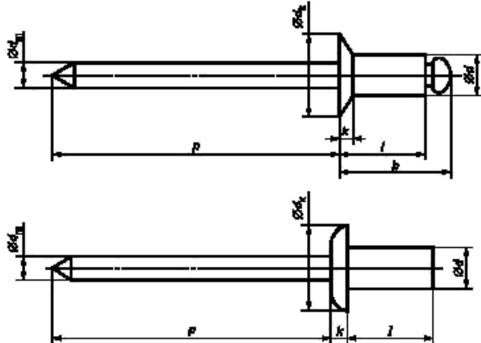
$d$  — слепая длина;  $d$  — диаметр заклепки;  $d_h$  — диаметр головки;  $d_m$  — диаметр сердечника;  $k$  — высота головки,  $l$  — длина заклепки;  $p$  — выступающая длина сердечника
