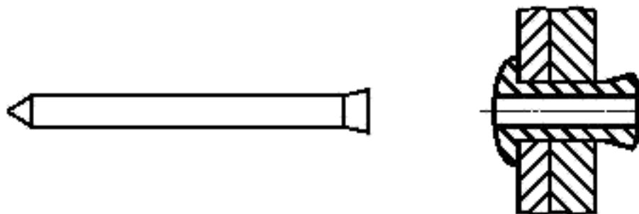
Рисунок 4 — Сердечник, протягиваемый насквозь
