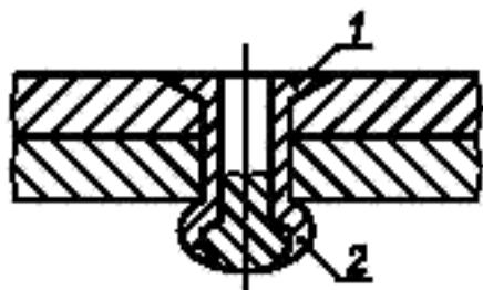
1 — головка «слепой» заклепки; 2 — «слепая» головка
