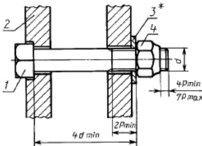
\* Провертывание шайбы не допускается.
