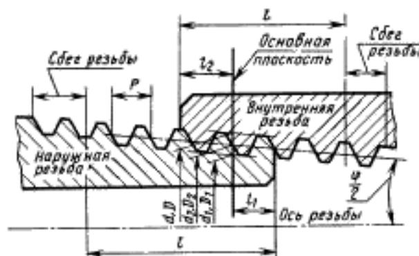
$l$  — рабочая длина резьбы;  $l_1$  — длина наружной резьбы от торца до основной плоскости;  $l_2$  — длина внутренней резьбы от торца до основной плоскости
