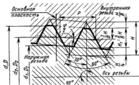
Конусность  $2\text{tg } \frac{\varphi}{2} = 1:16$ ;  $\varphi = 3^\circ 34' 48''$ ;  $\frac{\varphi}{2} = 1^\circ 47' 24''$
