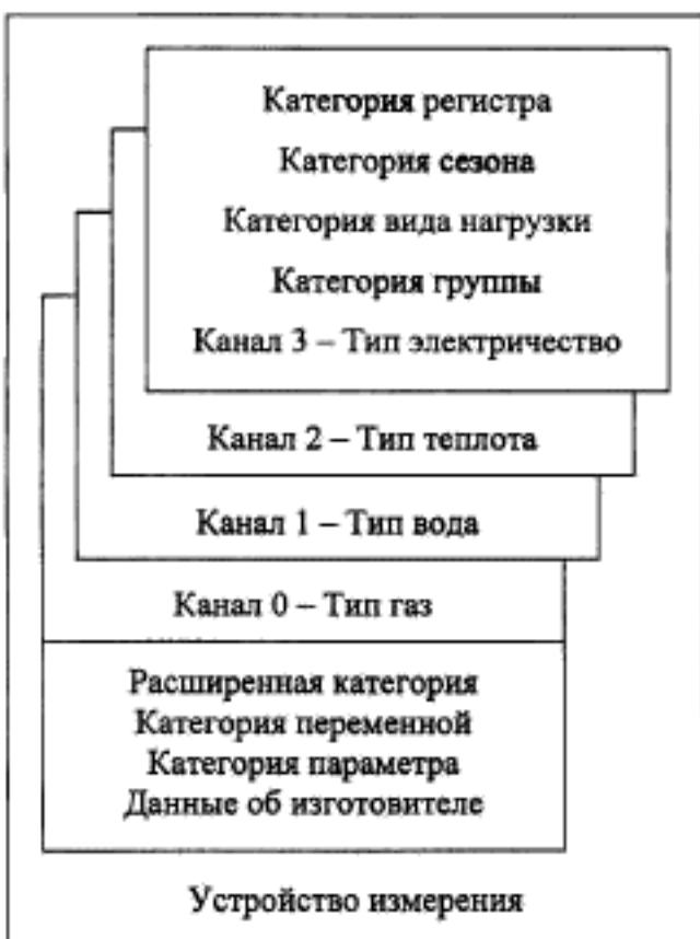
Рисунок В.1 — Пример использования типов канала
