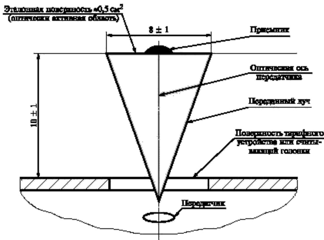
Рисунок 5 — Расположение передатчика при испытании
