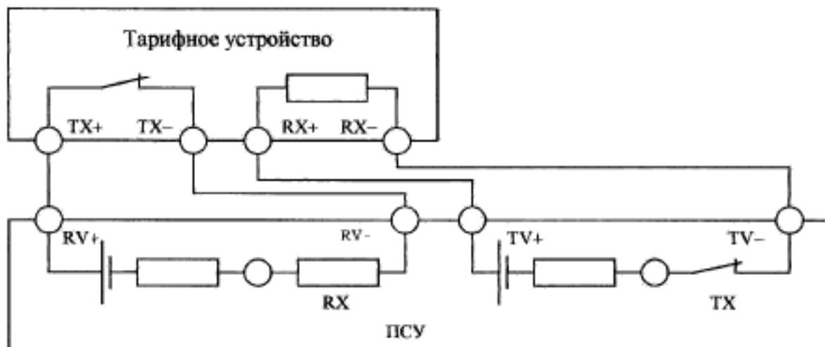
Рисунок 1в — Схема четырехпроводной линии с одним исполнителем
