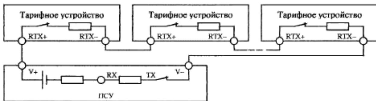
Рисунок 1б — Схема двухпроводной линии с несколькими исполнителями
