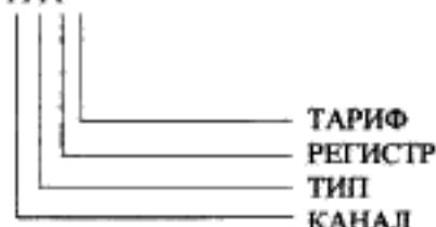
Единица в соответствующей битовой позиции указывает, что поле может принимать все возможные значения. Ноль указывает, что поле фиксировано. Таким образом, неиспользуемые места поля могут быть назначены так, чтобы все регистры КАНАЛА 1 читались или все записи РЕГИСТРА 1 по определенному каналу будут удалены и так далее.
