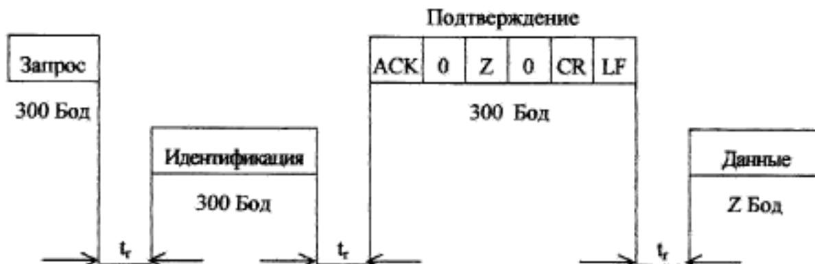
Протокол передачи для режима С, позволяющий считывание данных с подтверждением предложенной скорости передачи информации
