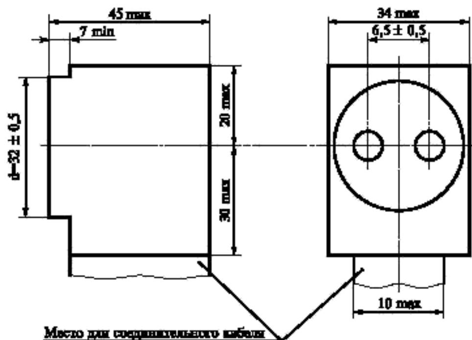
Рисунок 2б — Размеры считывающей головки
