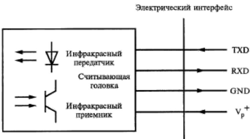
TXD — данные, снимаемые со считающей головки; RXD — данные, получаемые считающей головкой;
