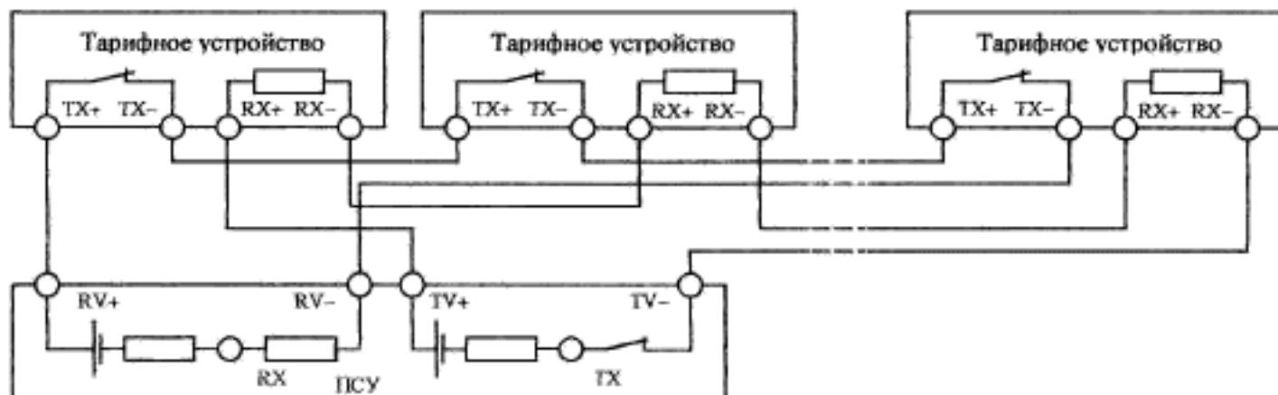
Рисунок 1г — Схема четырехпроводной линии с несколькими исполнителями
