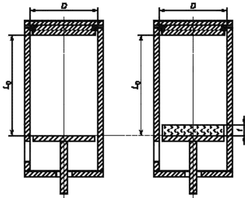
Рисунок А.2 — Схематическое изображение объемного резонатора с колебанием типа  $H_{01\rho}$  для измерений при фиксированной резонансной длине
