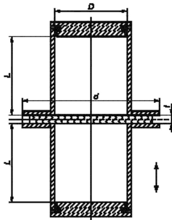
Рисунок А.3 — Схематическое изображение щелевого резонатора с колебанием типа  $H_{01\rho}$  с образцом
