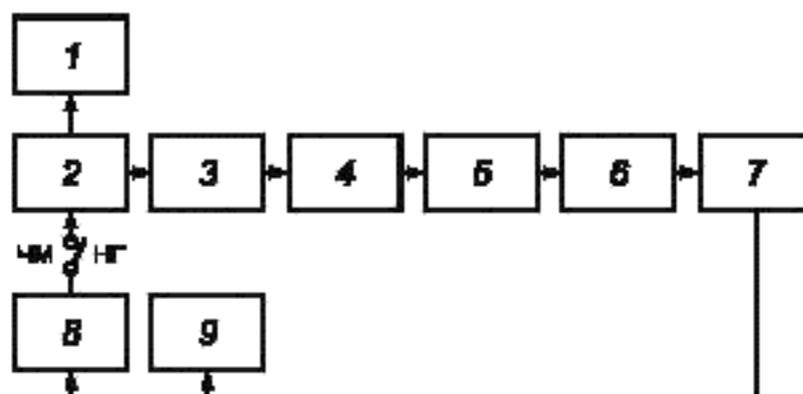
1 — частотомер; 2 — генератор СВЧ; 3, 6 — развязывающий вентиль; 4 — аттенюатор поляризационный; 5 — измерительный резонатор; 7 — детектор СВЧ; 8 — индикатор резонанса с выходом напряжения развертки, 9 — вольтметр
