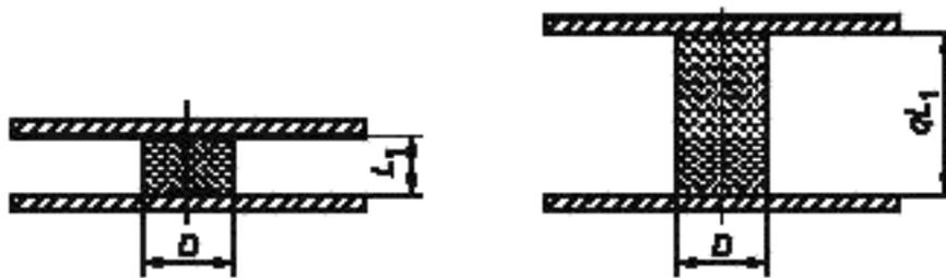
Рисунок Д.1 — Пояснение к измерению глубины скин-слоя в МДР с кратными высотами
