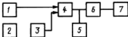
1 — генератор периодических импульсов точной амплитуды; 2 — источник кобальт-60; 3 — детектор гамма-излучения с предусилителем и усилителем; 4 — линейный сумматор; 5 — измеритель скорости счета импульсов; 6 — анализатор; 7 — устройство вывода данных в цифровой форме
