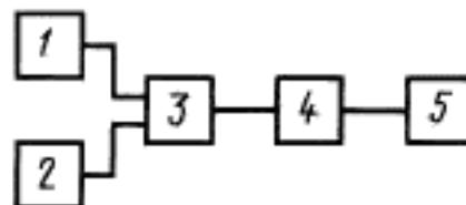
1 — генератор периодических импульсов точной амплитуды; 2 — генератор шума; 3 — линейный сумматор; 4 — анализатор; 5 — устройство вывода данных в цифровой форме
