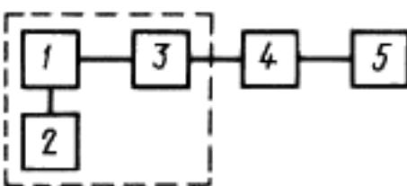
1 — генератор линейно-изменяющегося напряжения; 2 — регулируемый источник постоянного напряжения; 3 — линейный сумматор; 4 — анализатор; 5 — устройство вывода данных в цифровой форме
