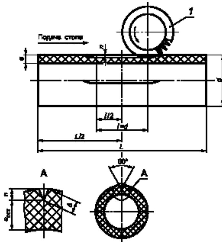
$d$  — наружный диаметр трубы;  $e$  — толщина стенки трубы;  $e_{\text{ост}}$  — остаточная толщина стенки трубы;  $l$  — длина надреза;  $L$  — свободная длина образца по ГОСТ 24157;  $b$  — ширина надреза;  $n$  — глубина надреза;  $A$  — двусторонняя фреза с зубьями под углом  $60^\circ$
