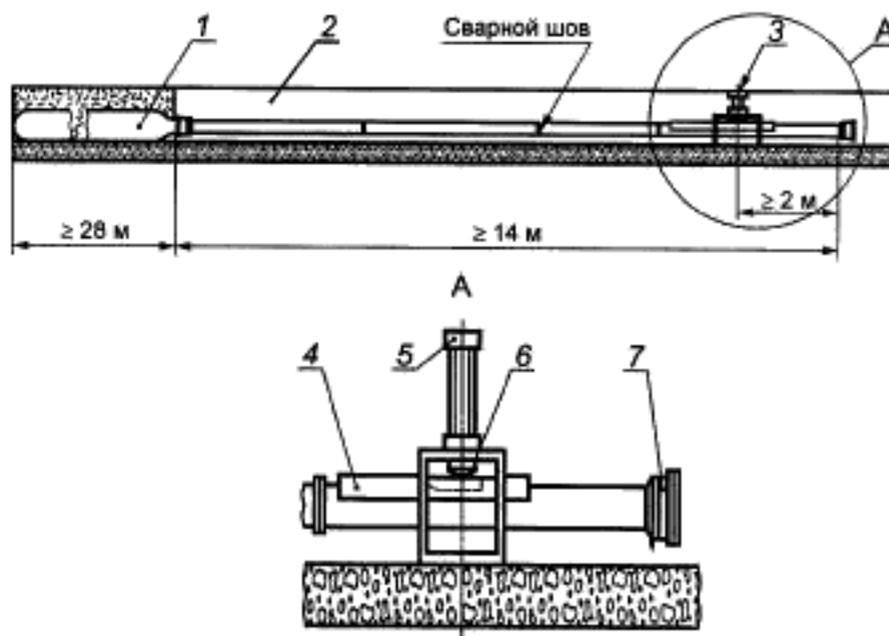
1 — стальной ресивер; 2 — канал; 3 — приспособление для инициирования трещины; 4 — рама для охлаждения;
