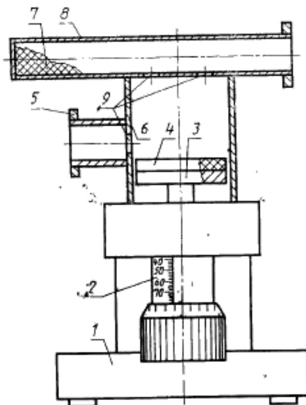
1—основание; 2—микрометрическая головка; 3—поршень; 4—образец, диэлектрик; 5—фланец; 6—резонатор; 7—поглотитель; 8—волновод; 9—отверстия связи
