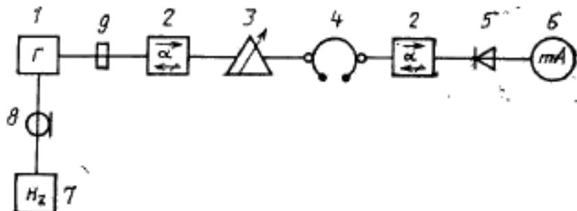
1—генератор СВЧ типа Г4—63; 2—ферритовый вентиль типа Э6—44; 3—волноводный поляризационный вттенюатор типа Д3—33А; 4—измерительная ячейка типа ОР-2М; 5—детекторная головка типа 27—6; 6—миллиамперметр типа М96 (10 мкА); 7—электронно-счетный частотометр типа Ч3—54 с преобразователем типа Я34-87; 8—коаксиальный проводник; 9—волновод.
