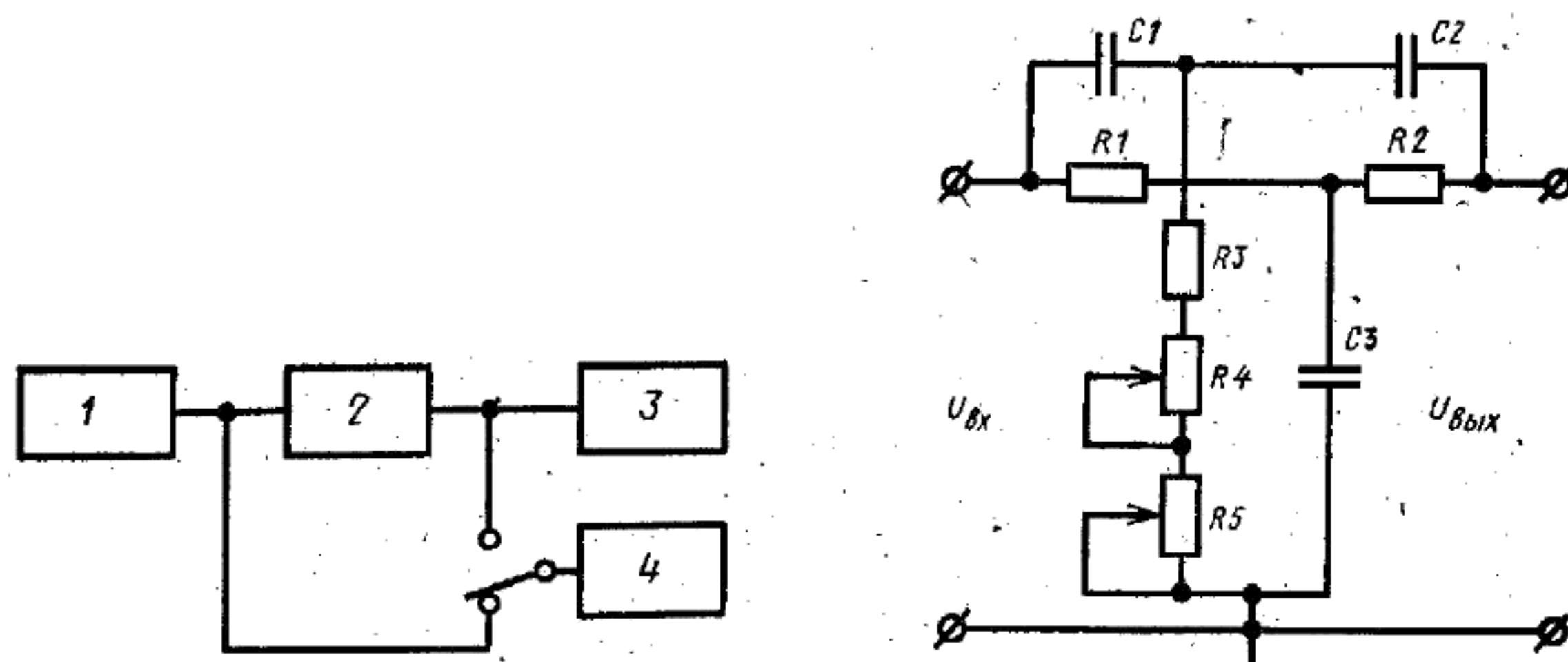
1—проверяемый генератор; 2—режекторный фильтр, 3—анализатор гармоник; 4—вольтметр
