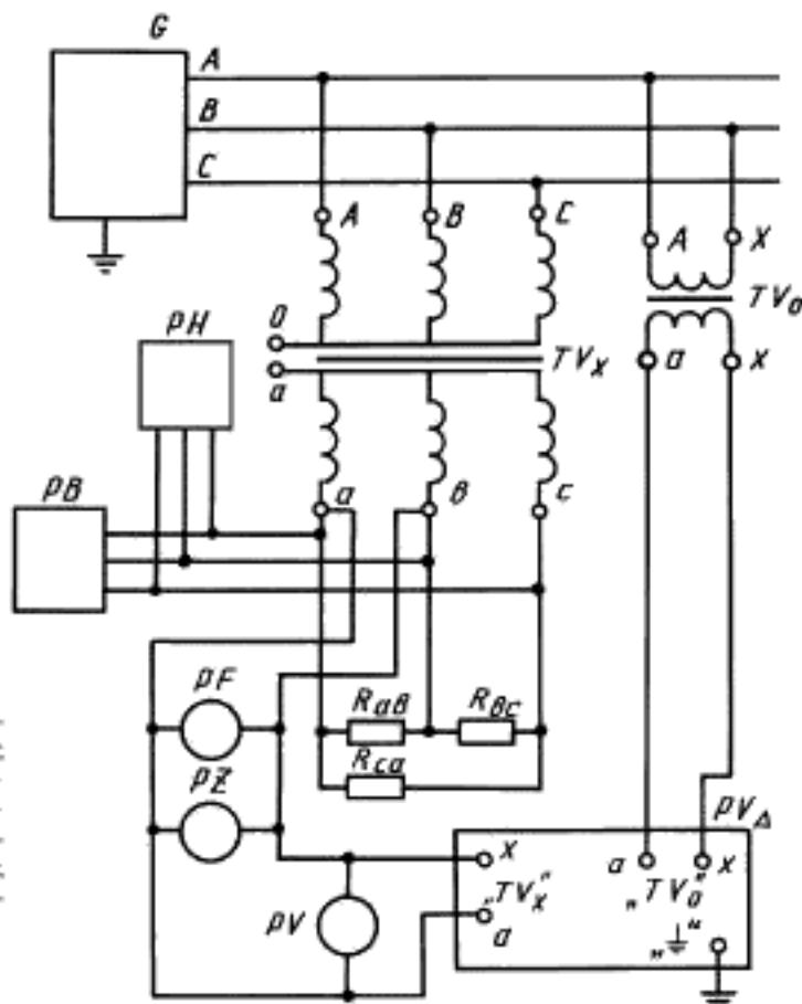
*G* — источник трехфазной системы напряжений;  $TV_x$  — поверяемый трансформатор;  $TV_o$  — образцовый трансформатор;  $RH$  — фазоуказатель;  $PB$  — измеритель несимметрии;  $PZ$  — измеритель нелинейных искажений;  $PF$  — частотомер;  $PV$  — вольтметр с пределом измерений 150 В (подключается в случае отсутствиястроенного вольтметра в приборе сравнения);  $R_{ab}$ ,  $R_{bc}$ ,  $R_{ca}$  — нагрузочные устройства поверяемого трансформатора;  $PV_A$  — прибор сравнения
