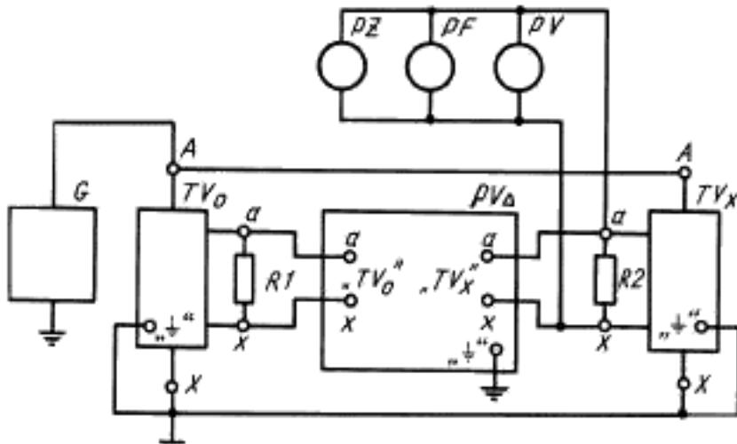
*G* — источник высокого напряжения, мощностью 25 кВ А; *TV<sub>0</sub>* — образцовый трансформатор; *R<sub>1</sub>* — нагрузочное устройство образцового трансформатора; *PZ* — измеритель нелинейных искажений; *PF* — частотомер; *PV* — вольтметр с пределом измерения 150 В (подключается при отсутствии встроенного вольтметра в приборе сравнения); *PV<sub>d</sub>* — прибор сравнения; *R<sub>2</sub>* — нагрузочное устройство поверяемого трансформатора; *TV<sub>x</sub>* — поверяемый трансформатор
