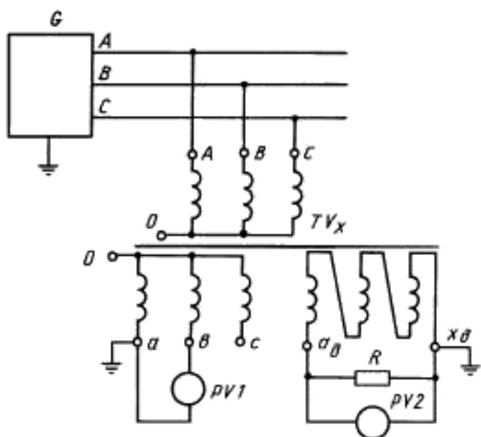
$TV_x$  — поверяемый трансформатор;  $G$  — источник трехфазной системы напряжений;  $PV1$  — вольтметр с пределом измерения 150 В;  $PV2$  — вольтметр с пределом измерения 5—7 В;  $R$  — нагрузочное устройство дополнительной обмотки
