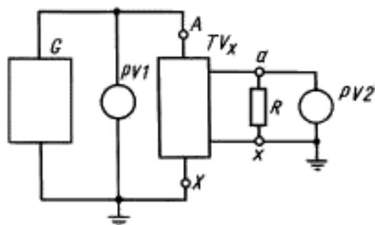
*G* — источник высокого напряжения; *TV<sub>x</sub>* — поверяемый трансформатор; *PV<sub>1</sub>, PV<sub>2</sub>* — образцовые вольтметры; *R* — нагрузочное устройство
