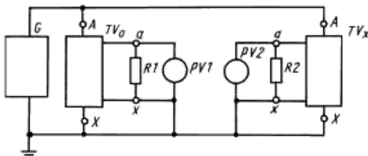
*G* — источник высокого напряжения; *TV<sub>o</sub>* — образцовый трансформатор; *TV<sub>x</sub>* — поверяемый трансформатор; *R<sub>1</sub>, R<sub>2</sub>* — нагрузочные устройства образцового и поверяемого трансформаторов; *PV<sub>1</sub>, PV<sub>2</sub>* — образцовые вольтметры
