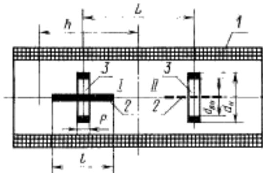
1—соленоид; 2—образец; 3—катушки индукционного преобразователя.
