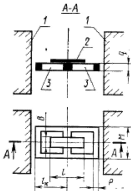
1—полюсные макронечники электромагнита; 2—образец; 3—катушки индукционного преобразователя
