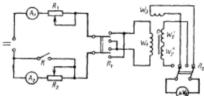
$R_1, R_2$  — регулировочные резисторы;  $A_1, A_2$  — амперметры;  $K$  — ключ;  $P_1, P_2$  — двухполюсные переключатели;  $W_1, W_2$  — катушки индукционного преобразователя для измерения магнитного потока;  $W_3$  — измерительная катушка;  $\mu$  — обмотка намагничивающего устройства;  $\mu W_0$  — микровольтметр;  $O$  — образец.
