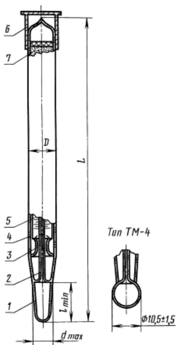
1 — резервуар; 2 — капиллярная трубка; 3 — седловина; 4 — оболочка; 5 — шкальная пластина; 6 — колпачок; 7 — крепежное устройство
