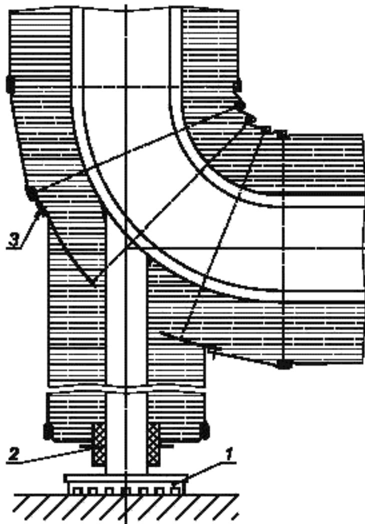
1 — виброзолирующая подушка; 2 — виброакустическая изоляция; 3 — мастичный герметик
