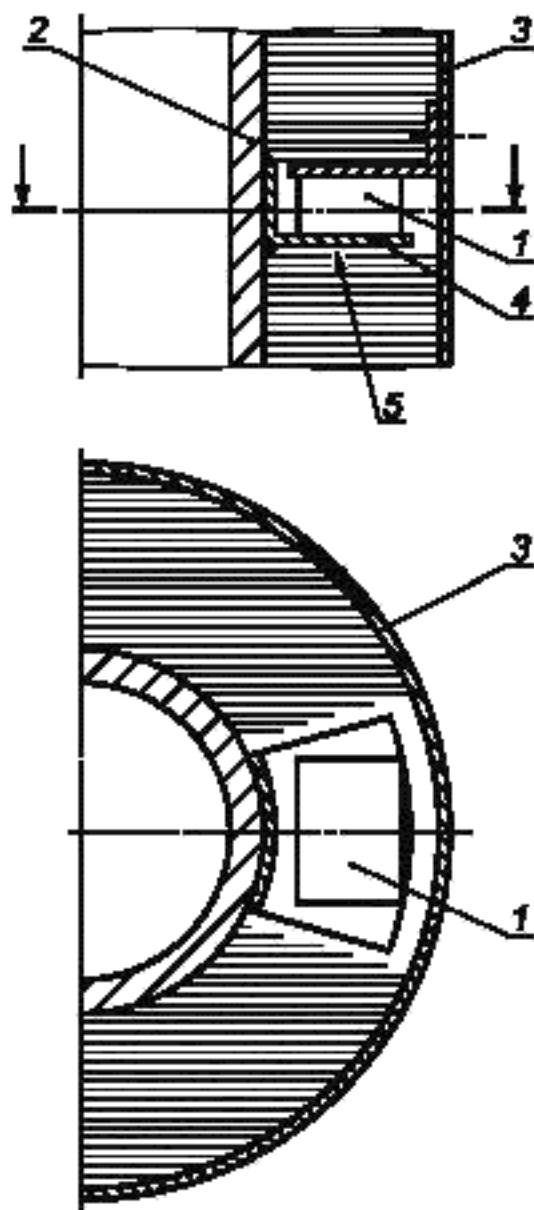
1 — виброизолирующая подушка; 2 — стенка трубы; 3 — обшивка; 4 — ребро, к которому привулканизована подушка; 5 — опора акустической изоляции
