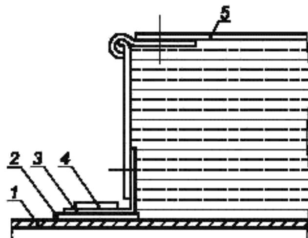
1 — обшивка облицованной трубы; 2 — клейкий мастичный герметик, 3 — фармованный профиль, 4 — бандажное кольцо (коррозионно-стойкое); 5 — обшивка
