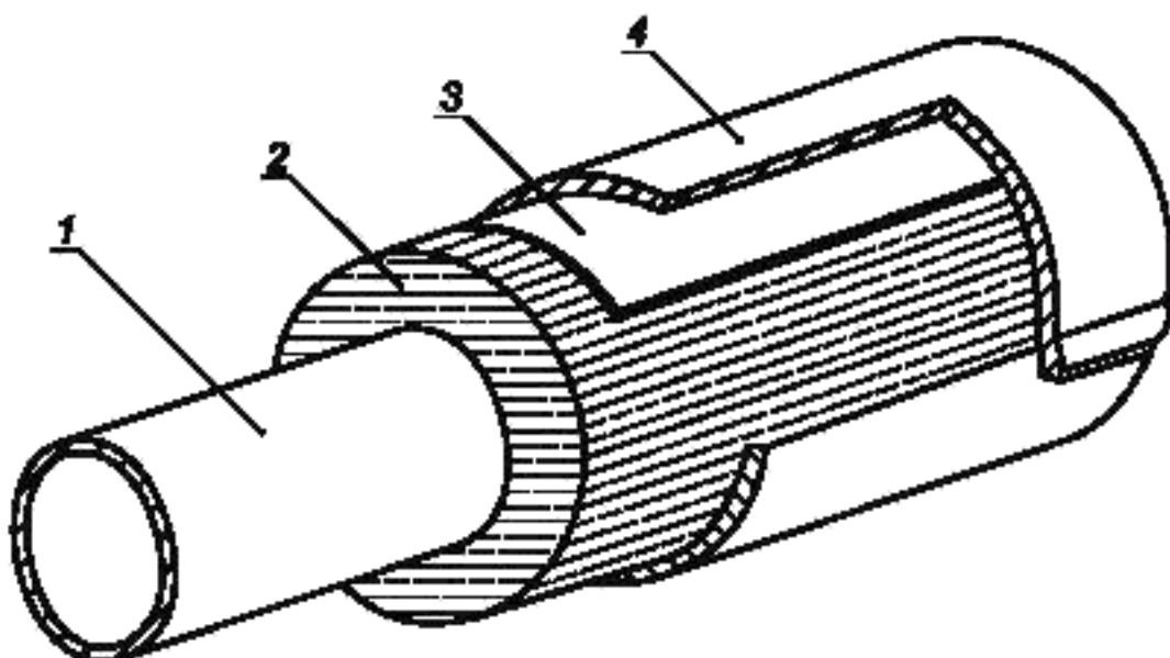
1 — труба; 2 — пористое покрытие, 3 — дополнительная масса и/или демпфирующее покрытие; 4 — обшивка
