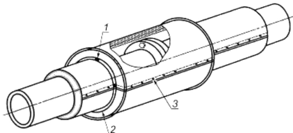
1 — опора; 2 — вентиляционное отверстие; 3 — детали крепления обшивки: заклепки, винты (не применяют, если обшивку накладывают непосредственно на пароизолирующее покрытие) или коррозионно-стойкие стальные скобы
