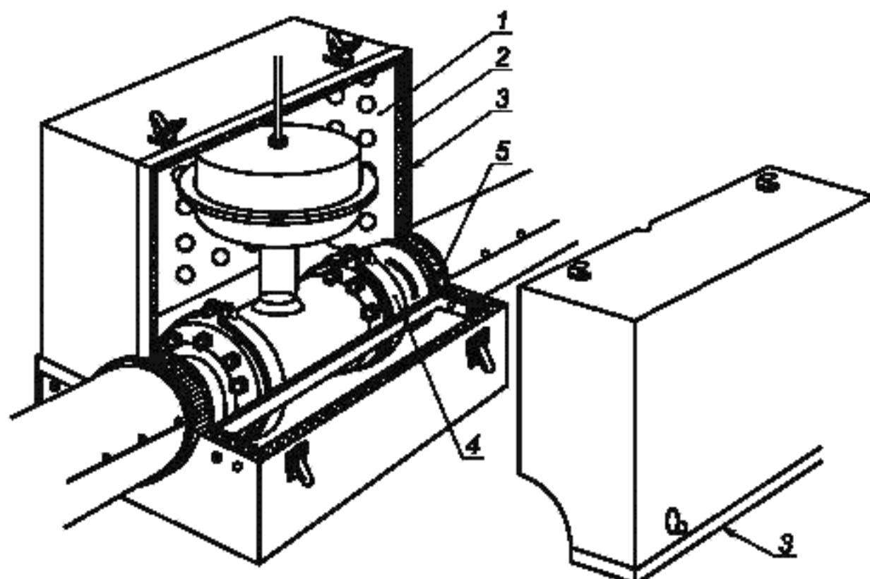
1 — перфорированный лист; 2 — пористый слой; 3 — направляющий буртик съемной части акустического ограждения; 4 — конструкция, поддерживающая фланцевое соединение (свиброизолирующей подушкой); 5 — виброакустическая изоляция
