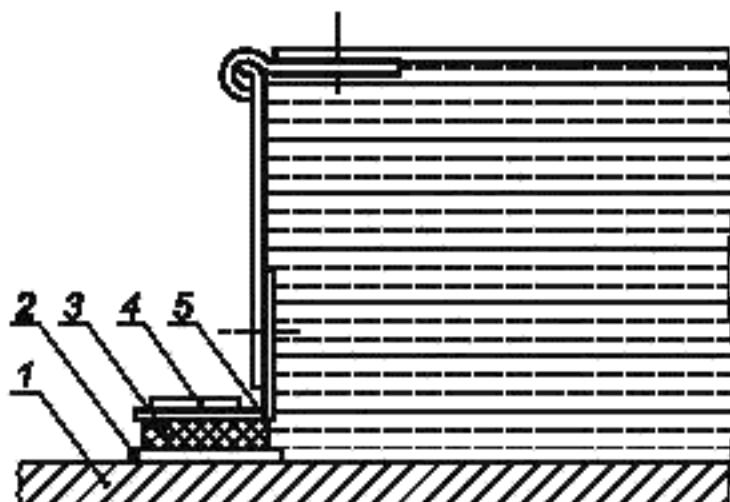
1 — труба; 2 — клейкое герметизирующее покрытие; 3 — виброакустическая изоляция; 4 — бандажное кольцо;
