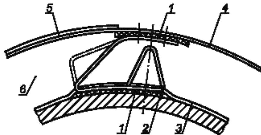
1 — упругая подушка; 2 — упругая опора обшивки, 3 — бандажное кольцо, 4 — опорное кольцо для обшивки; 5 — обшивка;
