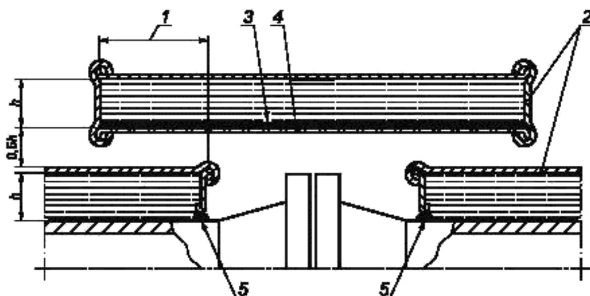
1 — перекрытие от 100 до 300 мм; 2 — обшивка; 3 — стеклоткань; 4 — перфорированный лист; 5 — вибропропорицирующий герметик (если требуется торцевая заглушка)
