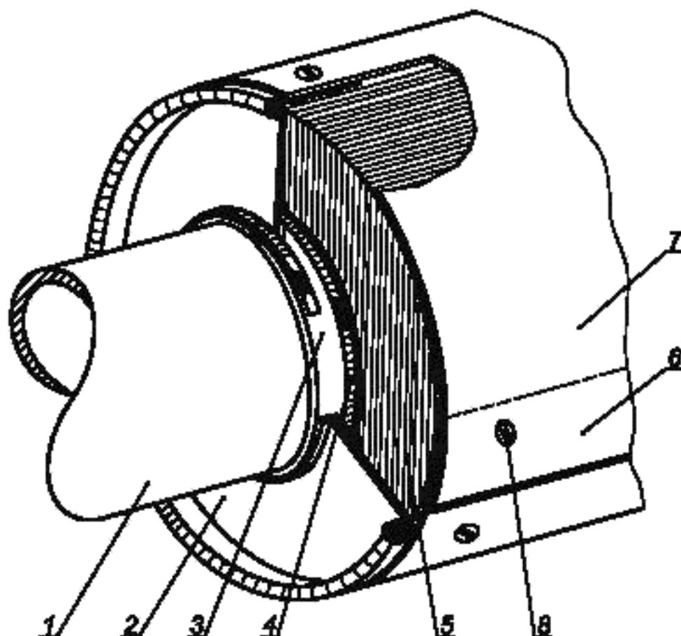
1 — труба; 2 — торцевая заглушка; 3 — виброакустическая изоляция [рисунок С.2а)]; 4 — бандажное кольцо; 5 — пористый слой; 6 — перекрытие по шву (продольный шов на деталях 4 и 5 для предохранения от попадания влаги); 7 — обшивка; 8 — крепление обшивки, заклепки, винты (не применяют, когда обшивку накладывают непосредственно на пароизолирующее покрытие) или коррозионно-стойкие стальные скобы
