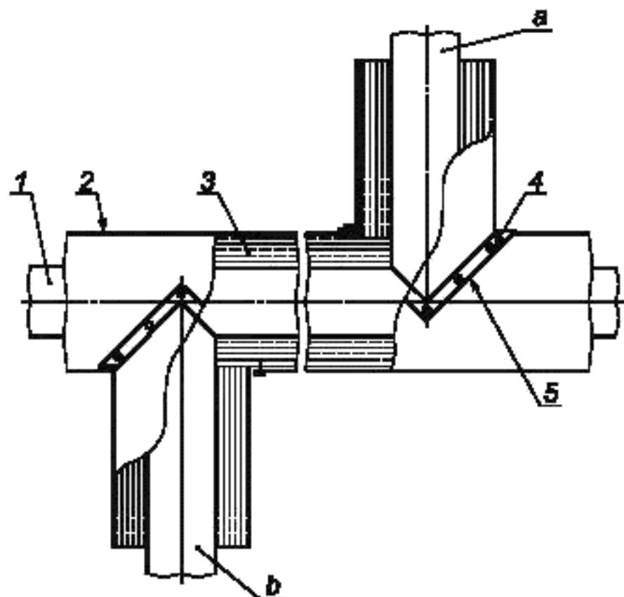
1 — труба; 2 — обшивка; 3 — пористый слой; 4 — винты или заклепки; 5 — мастичный герметик; а — верхний патрубок; б — нижний патрубок
