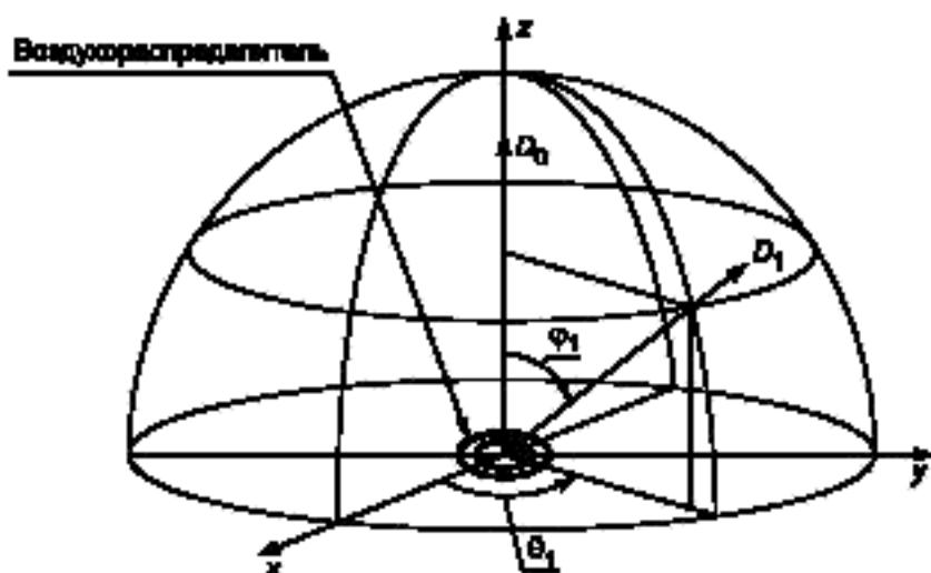
Рисунок В.1 — Система координат при определении показателя направленности диффузора ДМВ 200 для двух направлений.  $D_0$  — в направлении геометрической оси ( $\varphi_0 = 0^\circ$ ) и  $D_1$  — в направлении максимального звукоизлучения ( $\varphi_1 = 26^\circ$ ); ( $\theta_{0,1} = 0^\circ—360^\circ$ )
