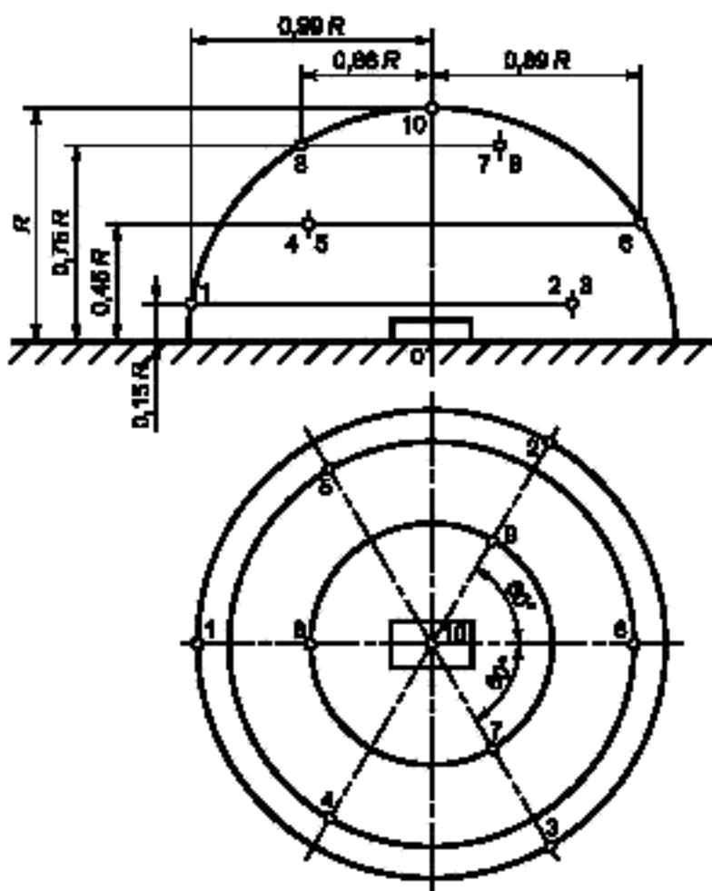
Рисунок А.1 — Положение микрофонов на полусфере
