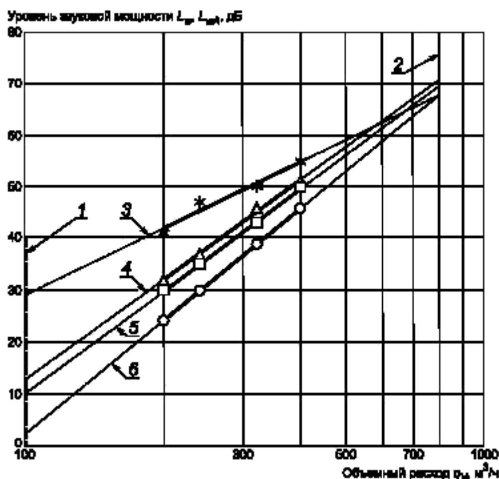
1 — нижняя граница области экстраполяции ( $0.5q_{V,\min}$ ); 2 — верхняя граница области экстраполяции ( $2q_{V,\max}$ ); 3 — 125 Гц ( $\blacksquare$ );
