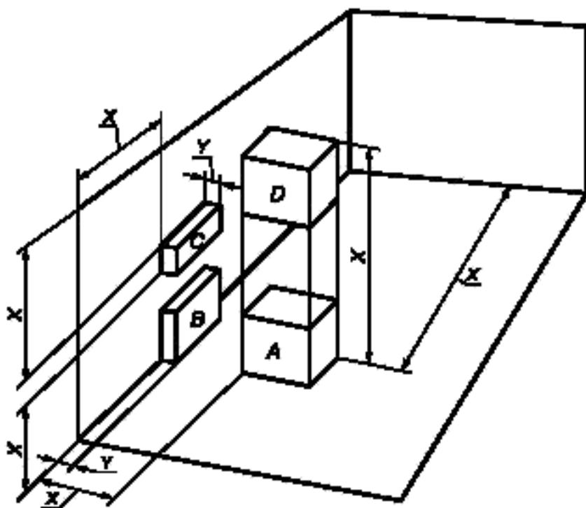
*A* — оборудование вдали от стены; *B* — оборудование, монтируемое вблизи пола или потолка и на стене или в стене; *C* — оборудование, монтируемое на стене или в стене; *D* — оборудование, подвешенное к потолку или закрепленное на нем или вмонтированное в потолок, *X* — минимальное расстояние от соседних поверхностей помещения, равное 1,5 м, если иное не установлено изготовителем; *Y* — рекомендованное изготовителем минимальное выступление оборудования в помещение
