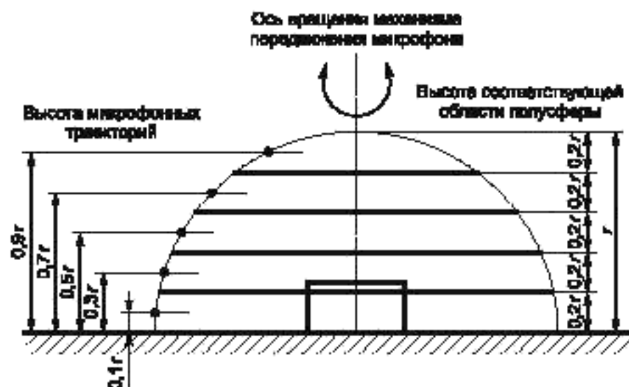
Рисунок Б.4 — Соосные круговые траектории в параллельных плоскостях для микрофонов, передвигаемых в свободном звуковом поле над звукоотражающей плоскостью
