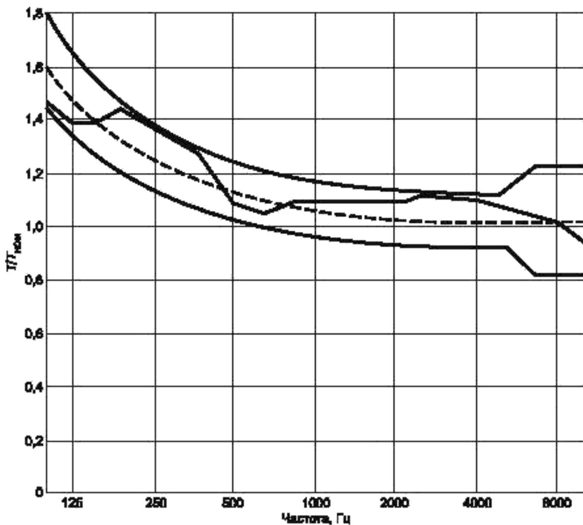
Рисунок Б.4 — Пределные кривые для отношения времени реверберации  $T$  к номинальному времени реверберации  $T_{nom}$  для камеры объемом  $70 \text{ м}^3$
