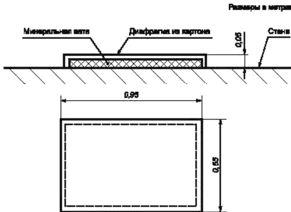
Рисунок Б.1 — Резонансный поглотитель с диафрагмой из картона
