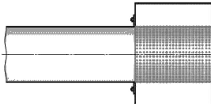
Рисунок D.1 — Канальный глушитель (разрез)
