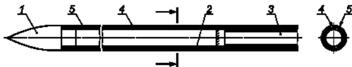
1 — носовой обтекатель; 2 — трубка со щелью; 3 — микрофон; 4 — щель; 5 — пористый материал
