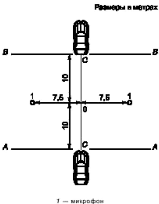
Рисунок 2 — Местоположения микрофонов
