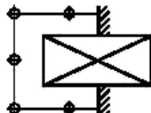
в) полусферическая измерительная поверхность перед глушителем
