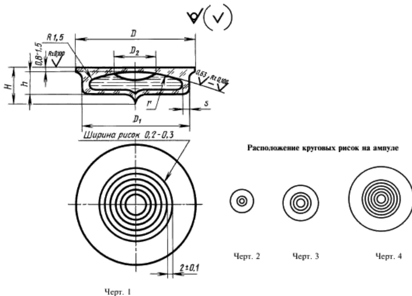
**П р и м е ч а н и е.** Допускается по требованию заказчика изготовление ампул без буртика, изображенного на черт. 1.
